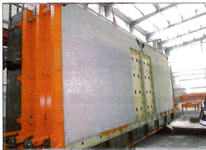
Figura N° 1.15.- Desencofrado del módulo "Llaxta"
