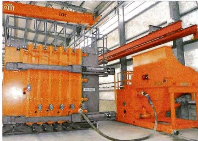
Figura N° 1.13.- Bombeo a presión de concreto al módulo
