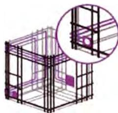
**Figura N° 1.20.- Colocación de ductos de agua y luz**
