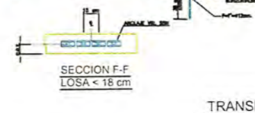
REFUERZO EN ZONA DE ANCLAJE PASIVO
