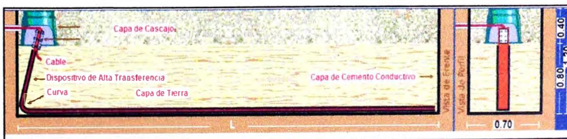
Fig. 4.19. Pozo a tierra de cemento conductor
