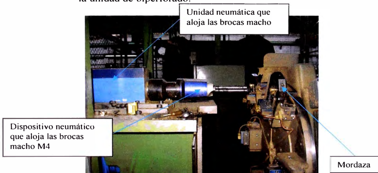
Figura 3.31: Unidad de roscado de la máquina suhner-PCI nueva
