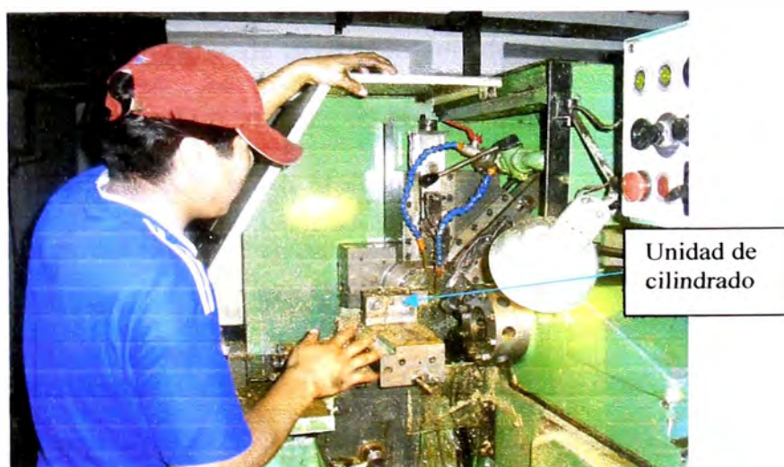
Figura 3.38: Máquina torno automático – 7P
