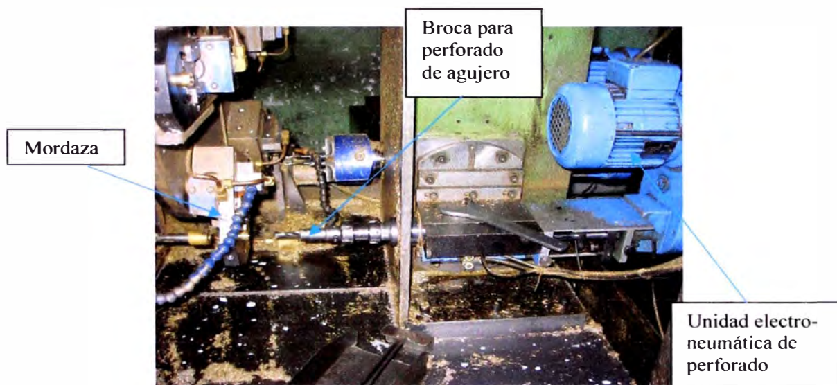
Figura 3.28: Unidad de perforado de agujero para cilindro de la máquina suhner-PCI nueva
