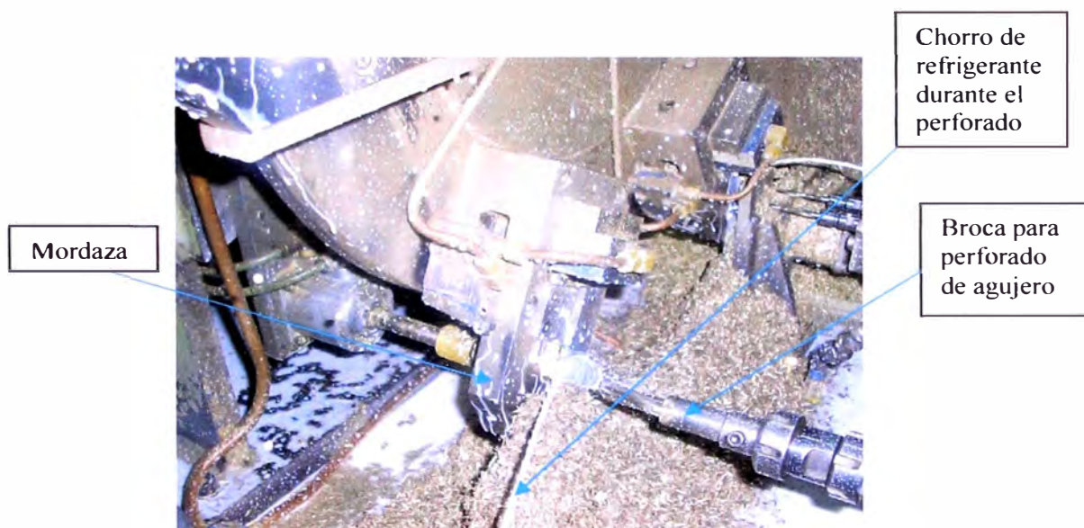
Figura 3.18: Unidad de perforado de agujero para cilindro de la máquina suhner-PCE
