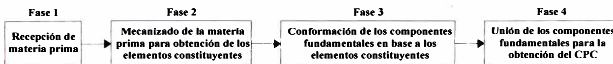
Figura 3.6: Fases del proceso de fabricación del conjunto porta cilindro (CPC)
