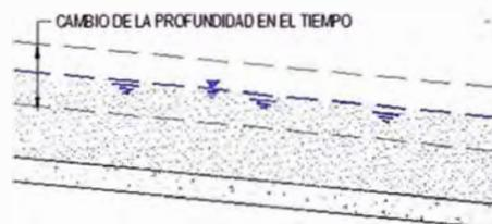
Figura 1.3 Flujo uniforme no permanente
