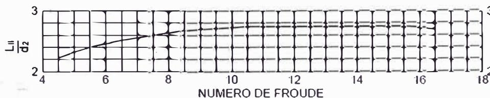
Figura 2.21 Longitud de resalto en función del número de Froude
