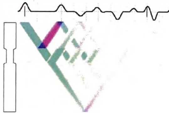
Figura 3.15: Pilote con estrechamiento a la mitad del pilote.
