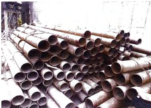
Figura 3.7: Tubería estructural Interior
