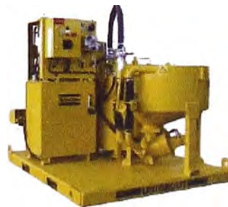
Figura 3.4: Central de Inyección.
