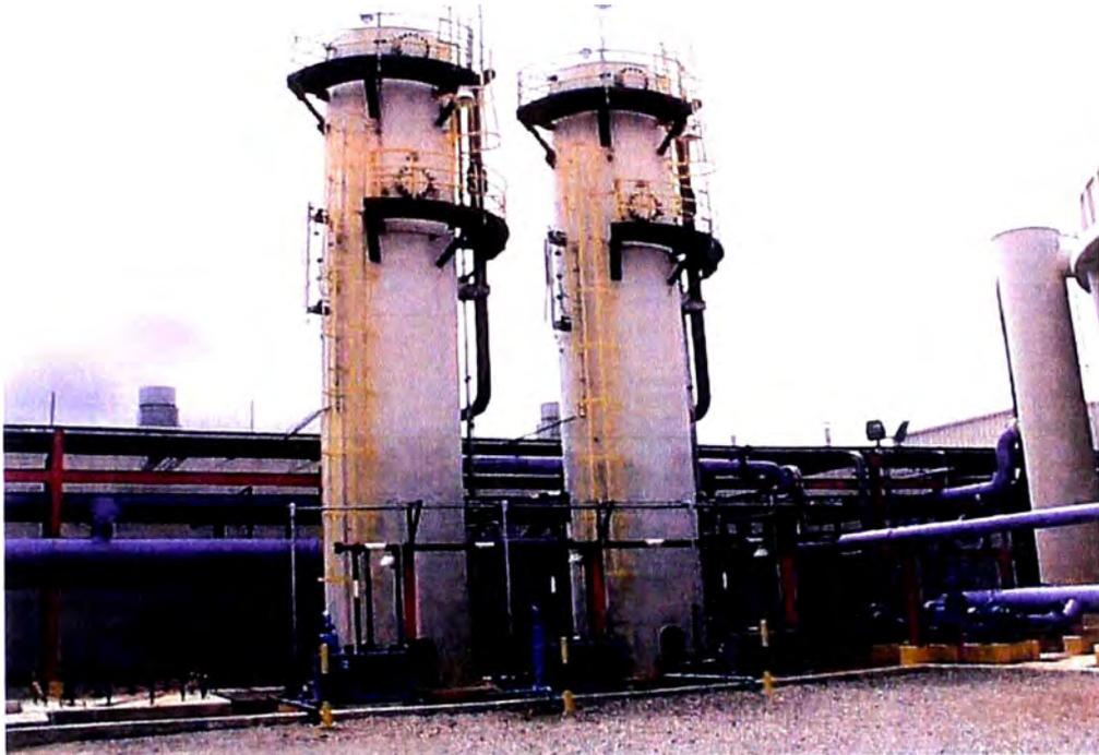
Figura 4.11 - Torres de vacío, planta Yanacocha Norte en Minera Yanacocha.
