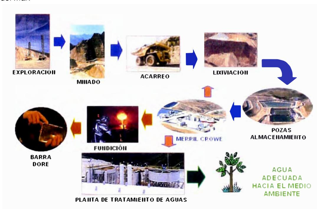
Figura 1.1 - Circuito de Producción de Oro por Lixiviación en Minera Yanacocha SRL.
