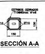
DETALLE TÍPICO EN BORDE VIVO XF-10
