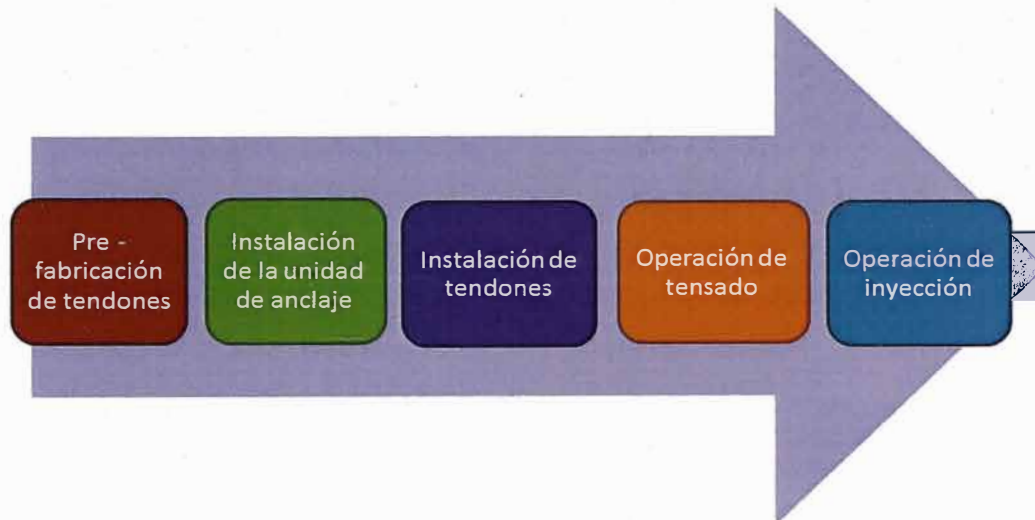
Figura N°1.4.- Procedimiento constructivo del sistema postensado (CCL, 2012)
