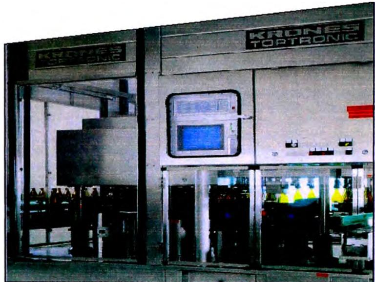
*Fig.2.11 Inspector Electrónico de Botellas*
