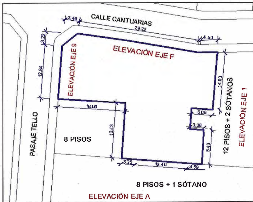
Figura N° 3.6: Frentes de ejecución de los muros anclados.
