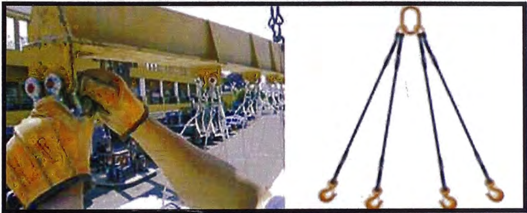
Figura 3.13: Equipos de izaje para las prelosas.
