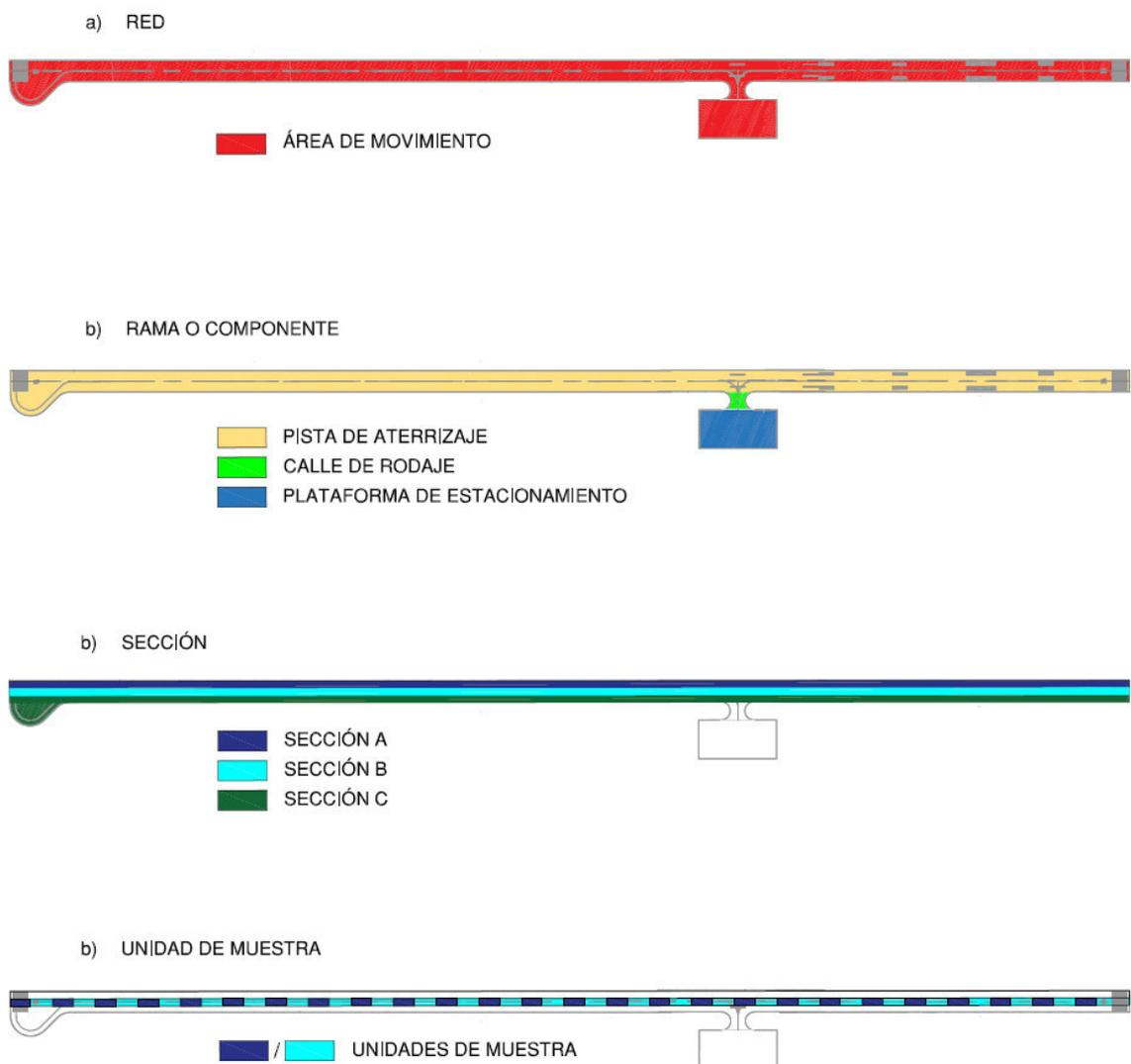
Figura 5. División de la red del pavimento
