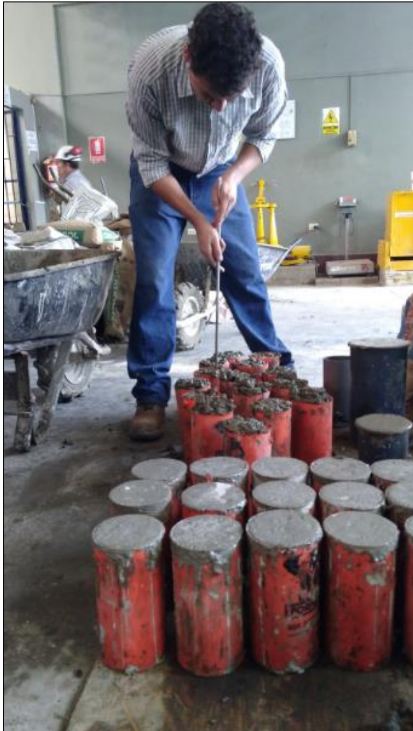
Figura N° 21: Llenado de moldes (chuceando)
