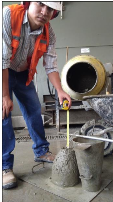
Figura N° 17: Determinación del asentamiento del concreto
