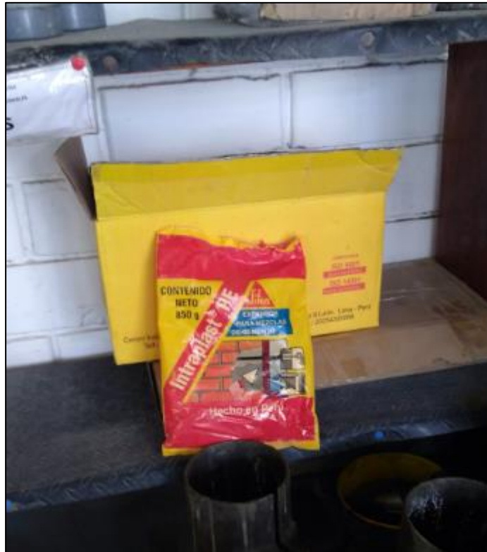
Figura N° 18: Uso del aditivo expansivo Intraplast Pe de Sika
