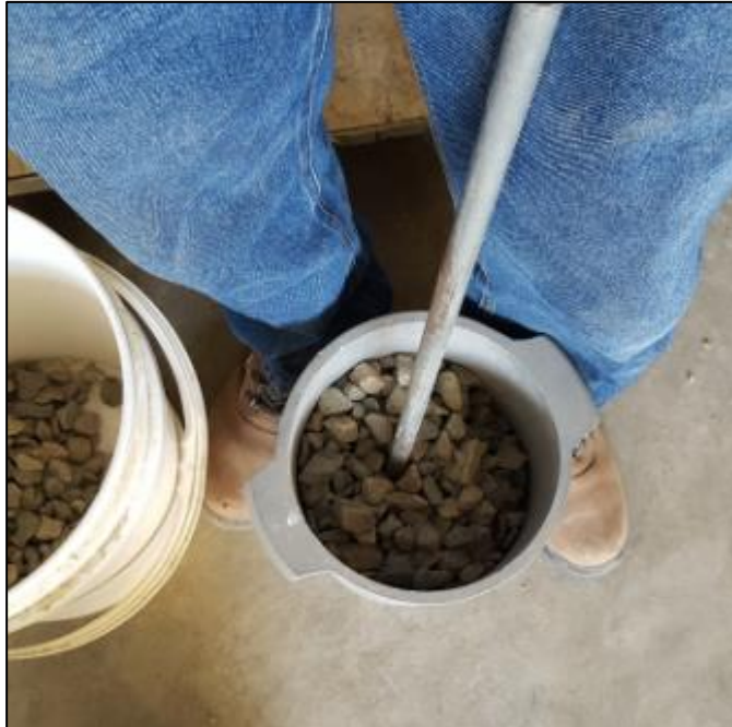
Figura N° 8: Compactado del agregado grueso
