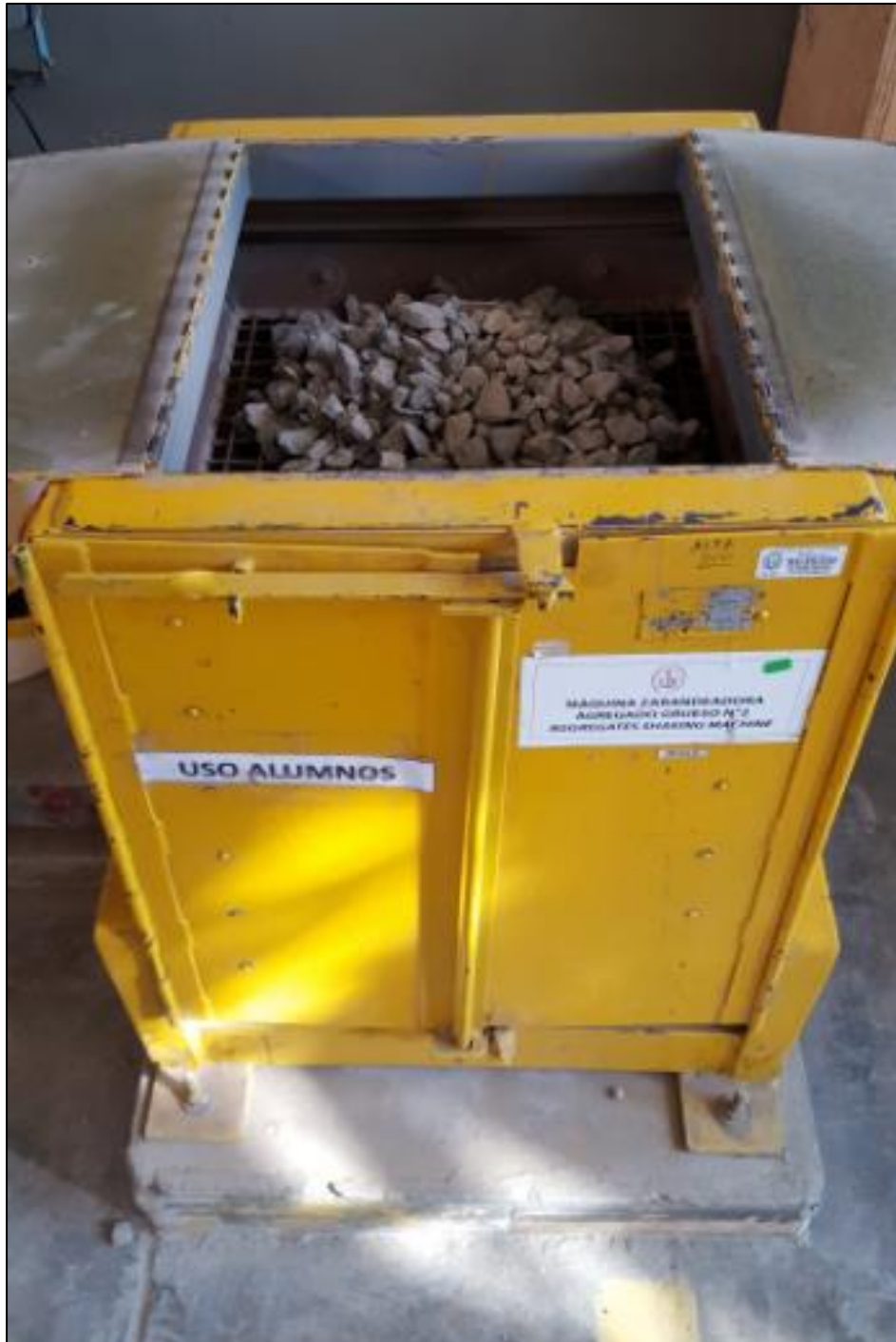
Figura N° 4: Tamizado del agregado grueso
