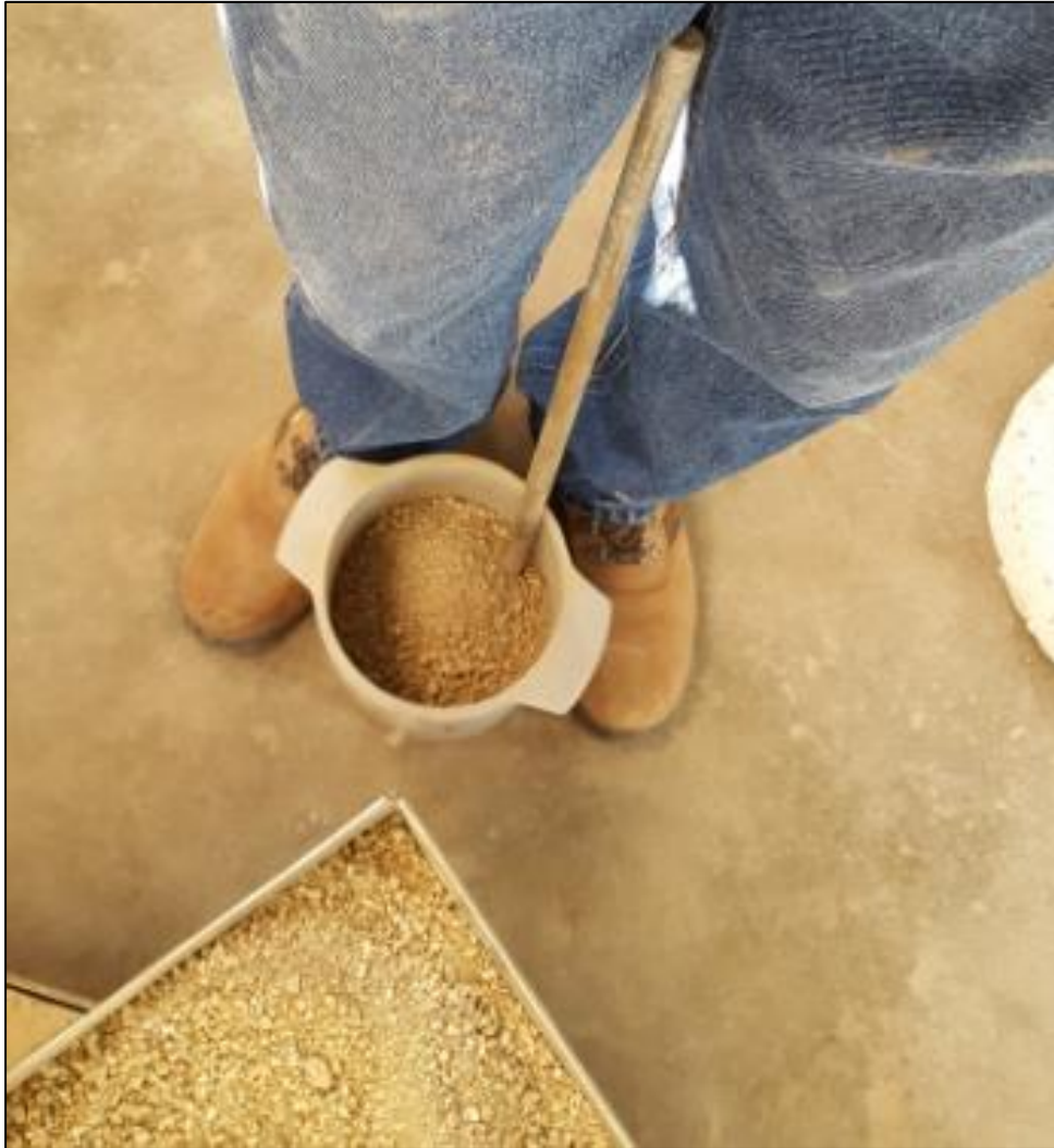
Figura N° 6: Compactado del agregado fino
