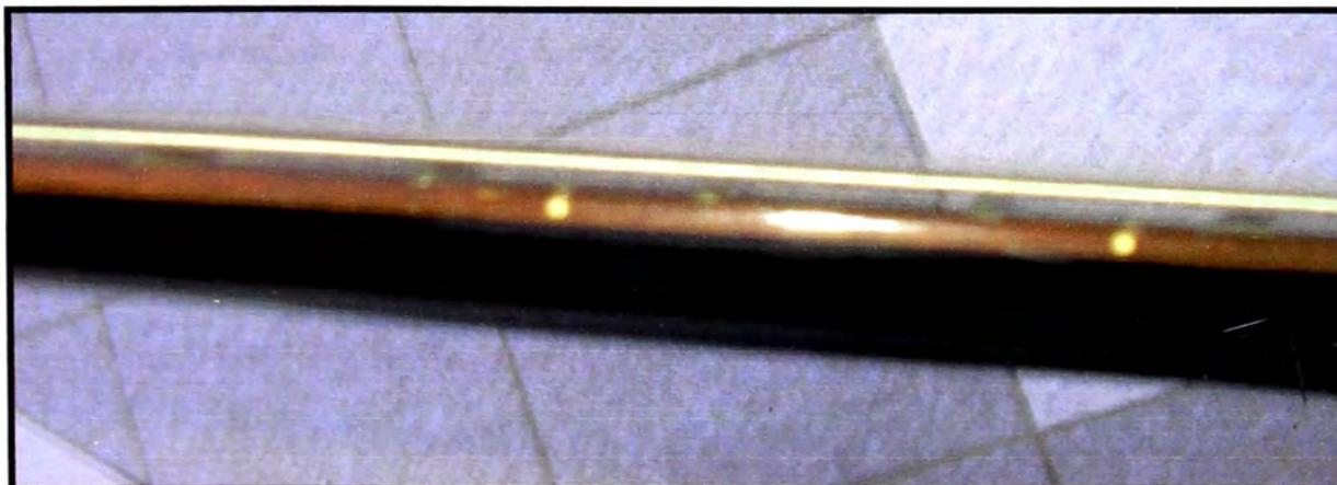
**Figura 5.10:** Altura en los trastes 5 y 7 después de ajustar el alma. Comparemos con la situación inicial (ver Figura 5.4), observamos notoriamente como las cuerdas se han acercado considerablemente al diapasón. Con los trastes pulidos correctamente, no generan el trasteo.
