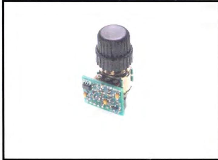
**Figura 4.16:** Preamp Activo. Potenciómetro concéntrico: agudos y graves.
