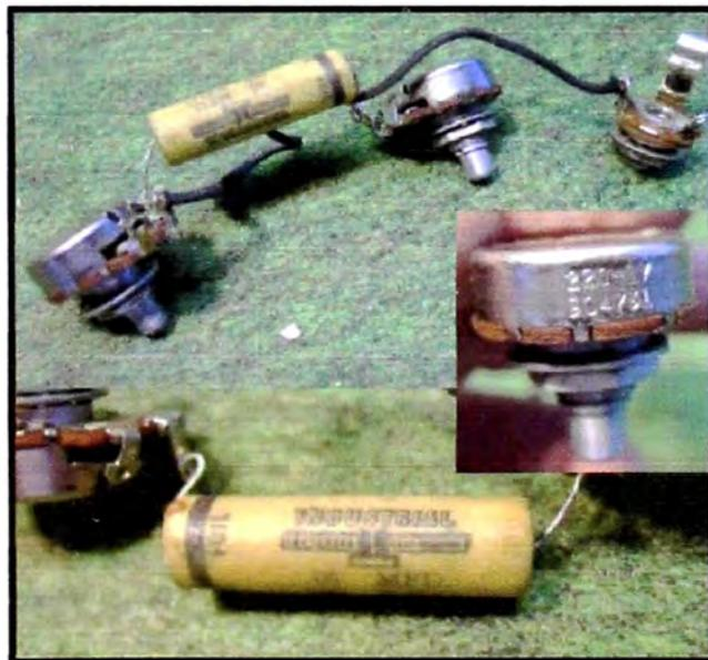
**Figura 4.11:** Preamp Pasivo. Circuito RC con potenciómetros simples.
