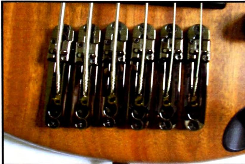
**Figura 4.24:** Sistema monorail. Sistema independiente por cuerda para evitar la vibración de las demás al momento de tocar. Muy rígido y estable. Difícil de calibrar pues se debe tensar y destensar hasta llegar a la posición correcta. Una vez calibrado no se vuelve a descalibrar.
