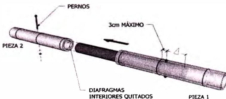
Unión colineal, con un perno transversales de  $\phi$  3/8 de pulgada.
