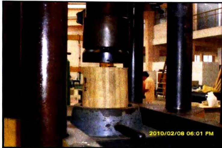
Figura N° 2.4 Ensayo de Compresión
