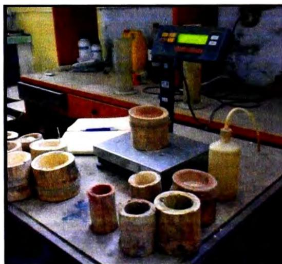
Figura N° 2.3 Ensayo de contenido de humedad
