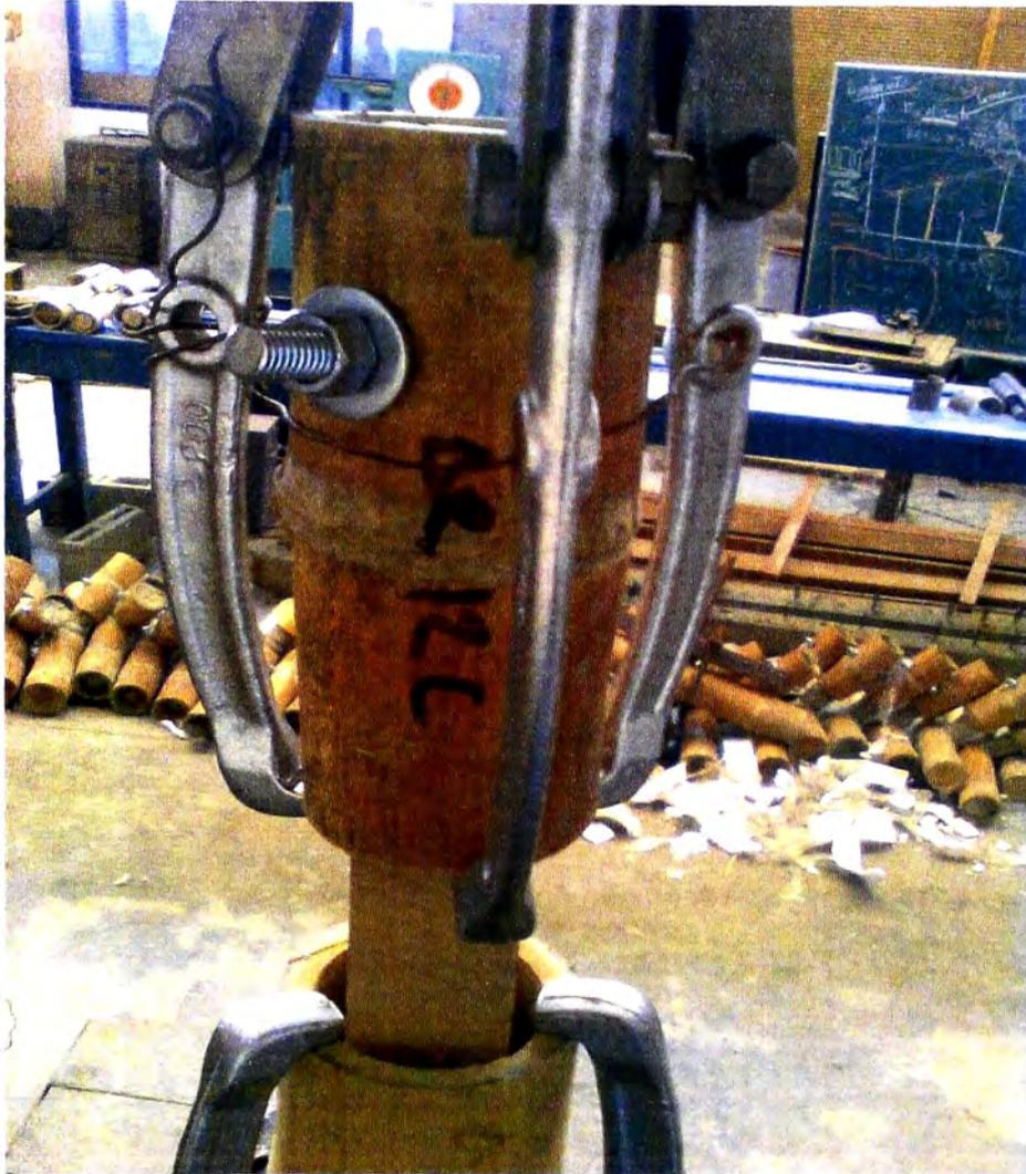
Figura N° 4.2 Unión colineal primera propuesta a ser ensayada en la máquina universal a tracción
