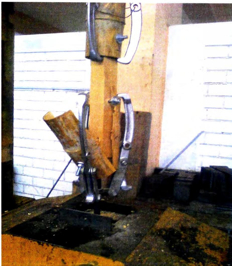
Figura N° 4.4 Unión colineal tercera propuesta a ser ensayada en la máquina universal a tracción
