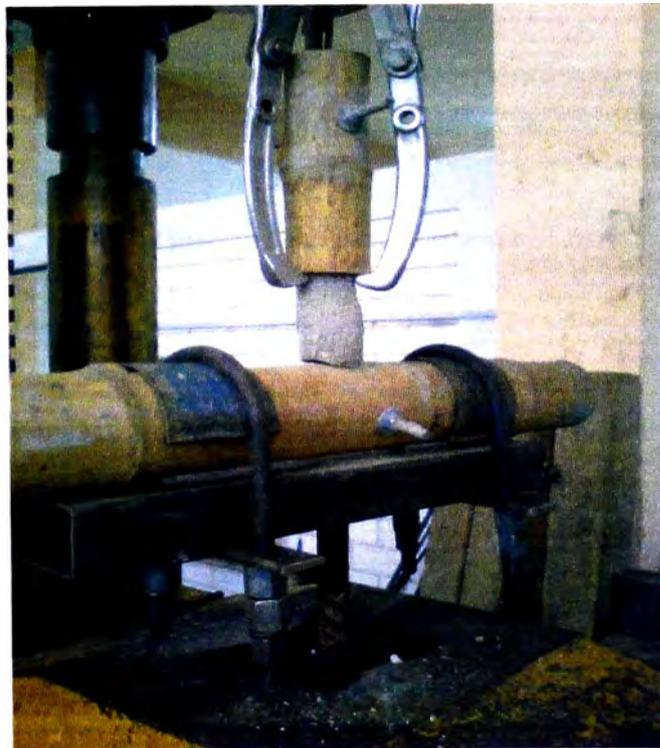
Figura N° 4.8 Unión perpendicular ensayada en máquina universal a tracción
