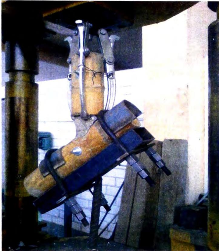
Figura N° 4.9 Unión diagonal a ser ensayada en la máquina universal a tracción
