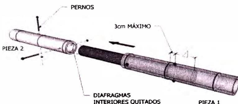
Unión colineal, con dos pernos transversales de  $\phi$  3/8 de pulgada.
