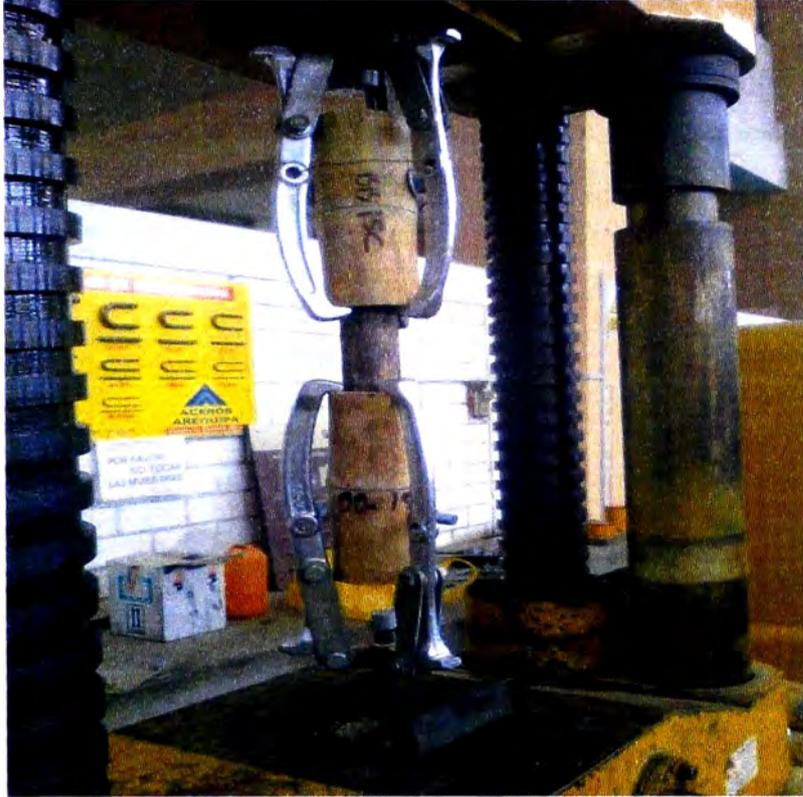
Figura N° 4.7 Unión colineal sexta propuesta a ser ensayada en la máquina universal a tracción
