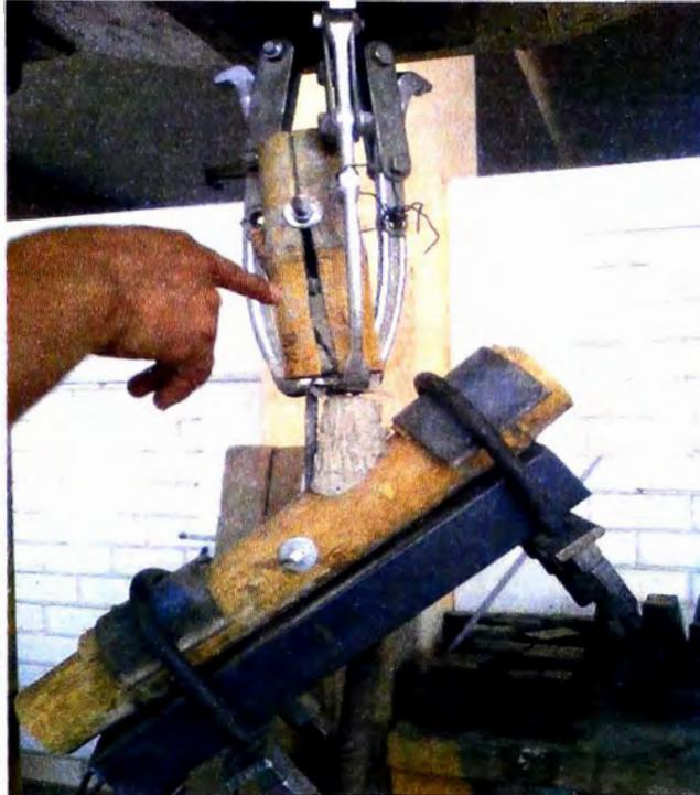
Figura N° 4.10 Unión diagonal a ser ensayada a los 21 días en la máquina universal a tracción
