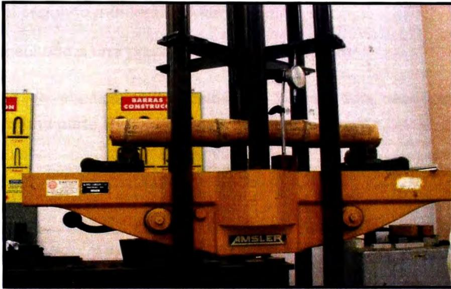
Figura N° 2.8 Ensayo de flexión a escala pequeña
