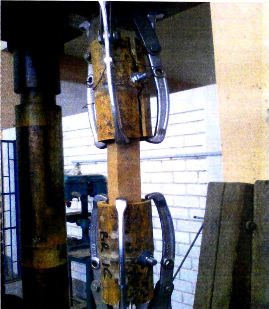
Figura N° 4.6 Unión colineal quinta propuesta a ser ensayada en la máquina universal a tracción
