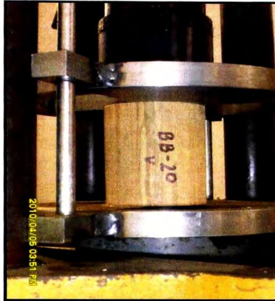
Figura N° 2.6 Ensayo de Corte
