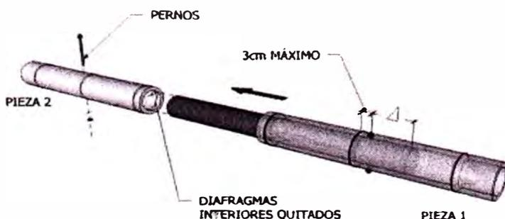
Unión colineal, con un perno transversales de  $\phi$  1/2 de pulgada.
