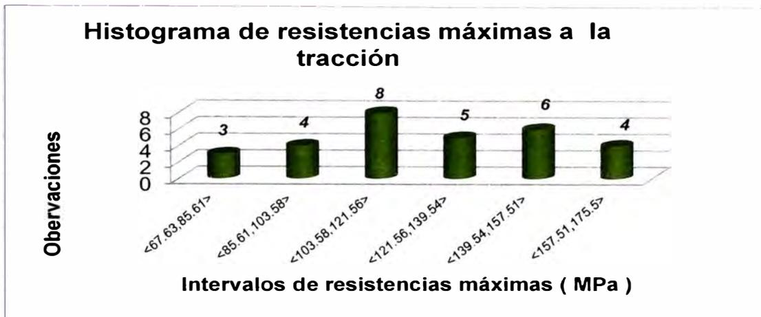
(a) En el gráfico 4.6 se observa que 8 especímenes presentan resistencias en el intervalo <103.58,121.56>MPa, seguido de 6 especímenes que presentan resistencias máximas de <139.54,157.51> MPa.
