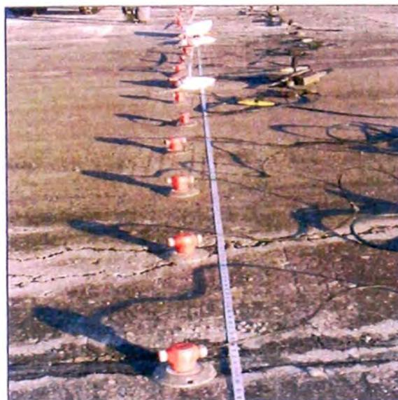
Figura 37: Vista de los geófonos para el ensayo MASW
