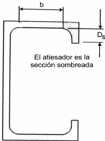
Figura 3.4.9.1-2; Elementos atiesados en el borde
