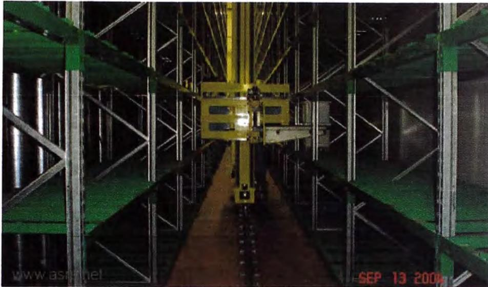
Figura 2.3 Sistema de almacenamiento y recuperación automatizado AS/RS.
