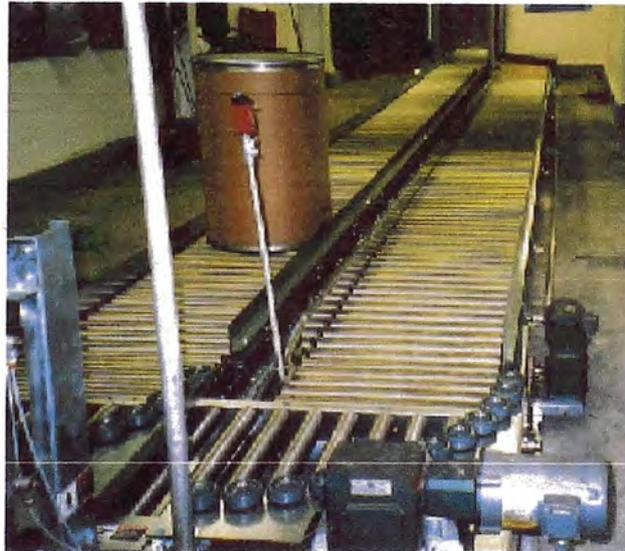
Figura 2.5 Transportadora de rodillos
