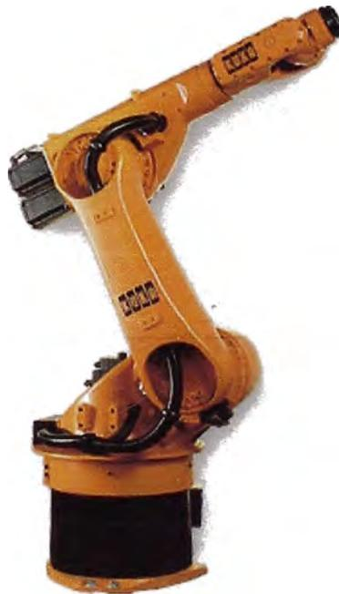
Figura 2.6 Robot manipulador articulado
