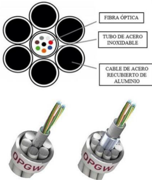
Figura N° 4 Sección de cable de guarda OPGW
