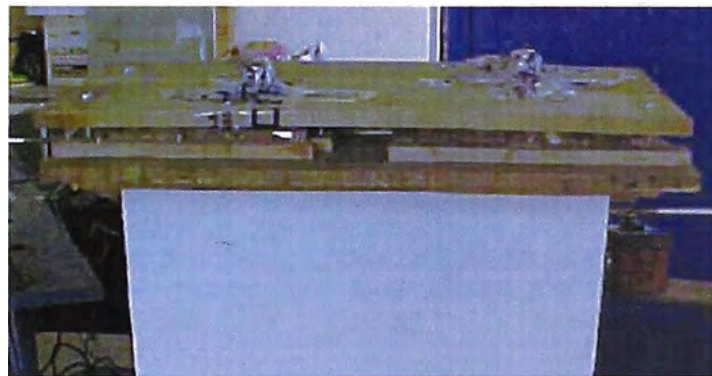
Figura N° 4.19.- Detalle de cargas. Se observa que las masas colocadas están cubiertas con tapas de madera para evitar el movimiento vertical de las mismas.
