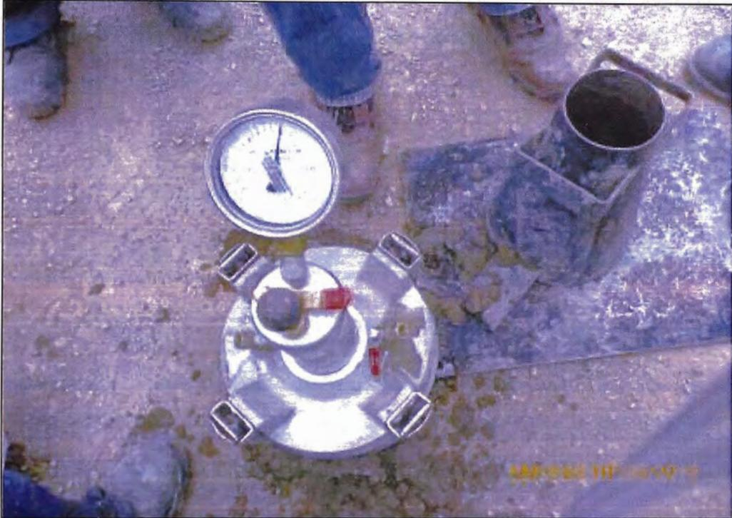
**Foto N°62.- Verificación del contenido de humedad con la olla de Washington, está dentro de los parámetros que establece la especificación técnica**
