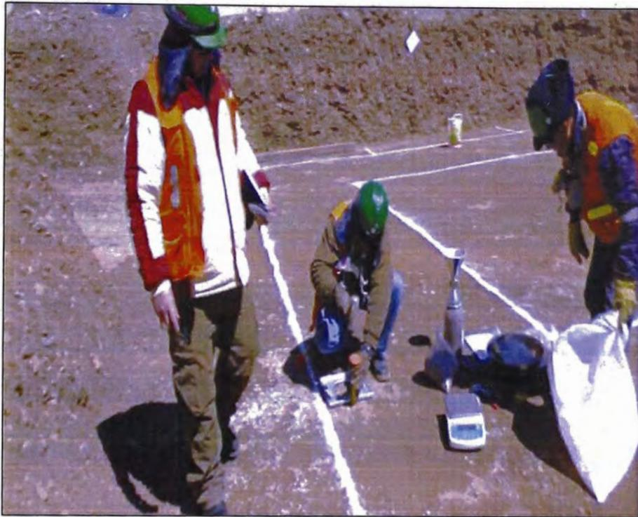
Foto N°35.- Prueba de densidad de campo teniendo una densidad mínima del 95%.
