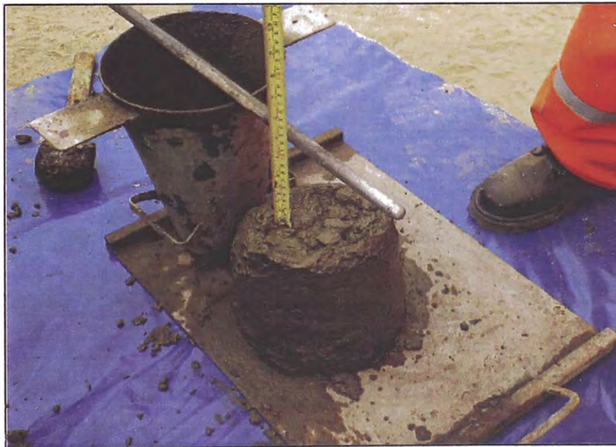
Figura 4.15: Verificación del Slump, contenido de aire y temperatura del Concreto Premezclado.
