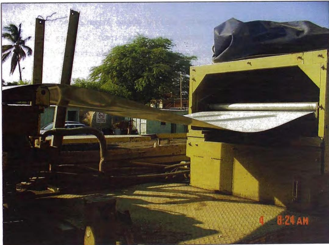
Fotografía N° 3.3. Ingreso de lámina en rodillos iniciales (Referencia 4)
