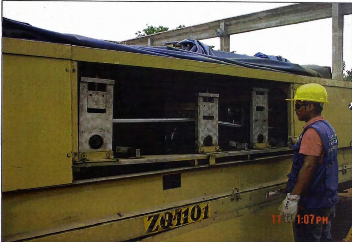
Fotografía N° 4.20. Rodillos moldeadores para sección (Referencia 4)
