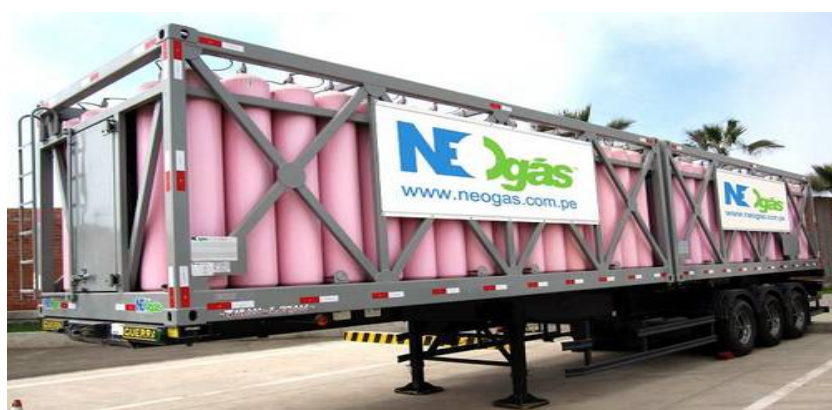
Figura N° 3.15 Semirremolque de almacenamiento de Neogas.
