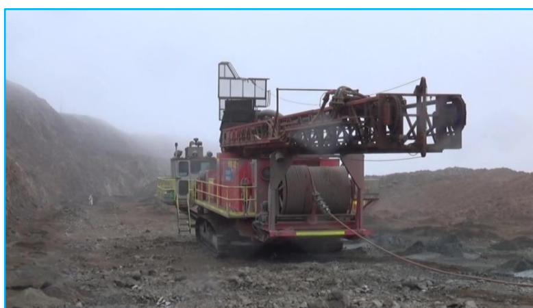
Figura 32.- Traslado de Perforadora Rotativa Eléctrica Sandvik 1190E.
