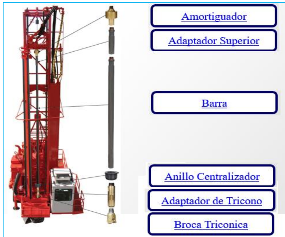
Figura 7.- Columna de Barrenos de Perforación Rotativa. Fuente: SANDVIK
