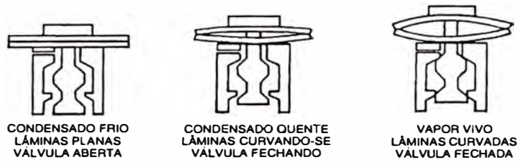
Figura 3.1.9 Trampas de vapor grupo termostatico
