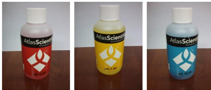
Fig. 5.2: Soluciones de calibración: buffer de pH 4 (izquierda), buffer de pH 7 (centro) y buffer de pH 10 (derecha).
