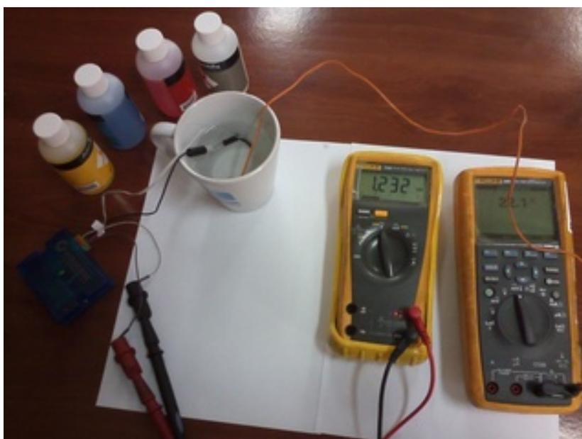
Fig. 5.3: Circuito para la calibración de los sensores.
