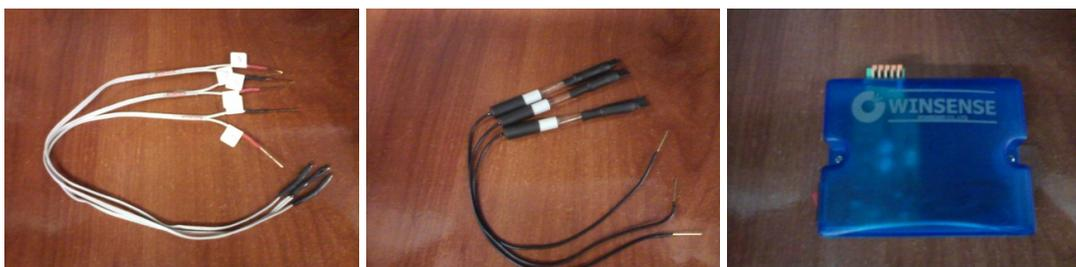
Fig. 5.1: Materiales proporcionados por WINSENSE: sensores ISFET (izquierda), electrodos de referencia (centro) y circuito de lectura (derecha).
