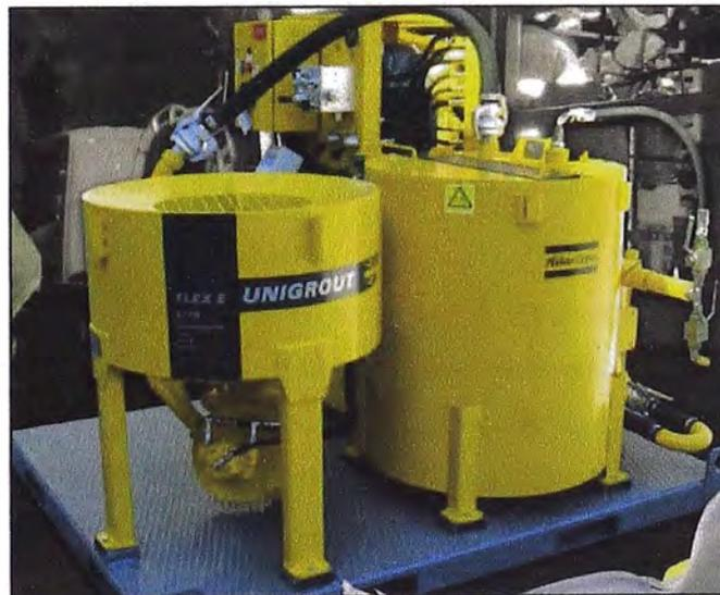
**Figura N°3.1.- Bomba de Inyección- Atlas Copco, UNIGROUT E22H**
