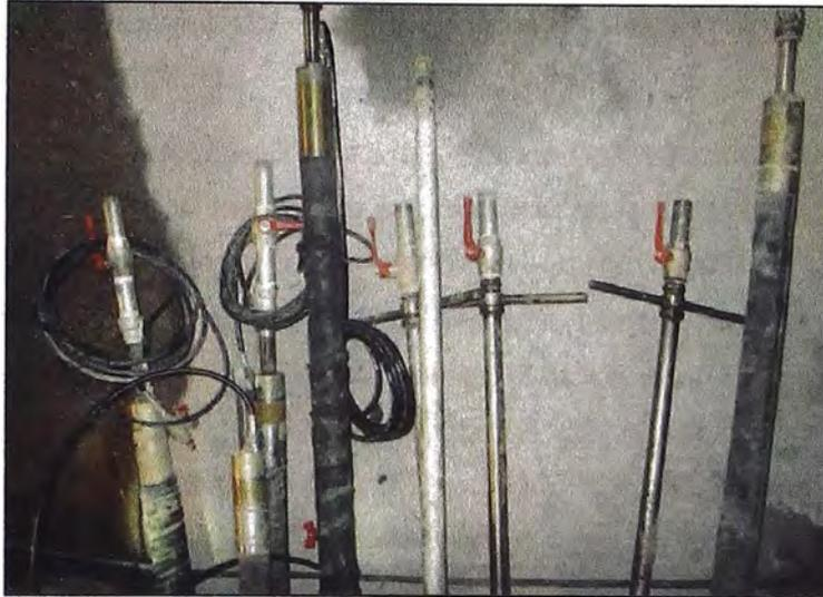
**Figura N°3.2.- Obturadores Hidráulicos y Mecánicos (Packers)**
