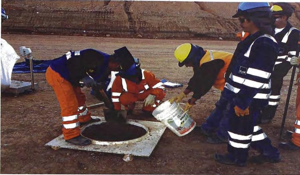
Figura 4.10. Pruebas de densidad método de reemplazo de agua.
