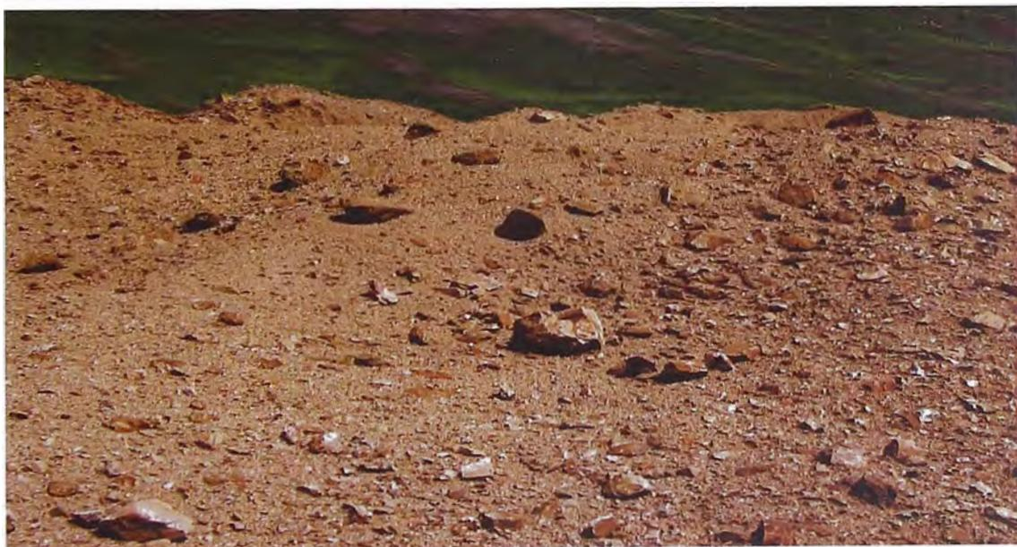
Figura 4.15. Material grueso producto de una voladura bien controlada
