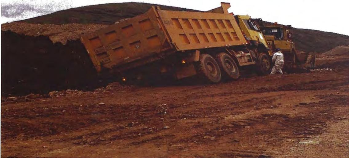
Figura 4.11. Cuneteo de volquete por falta de mantenimiento de vías.
