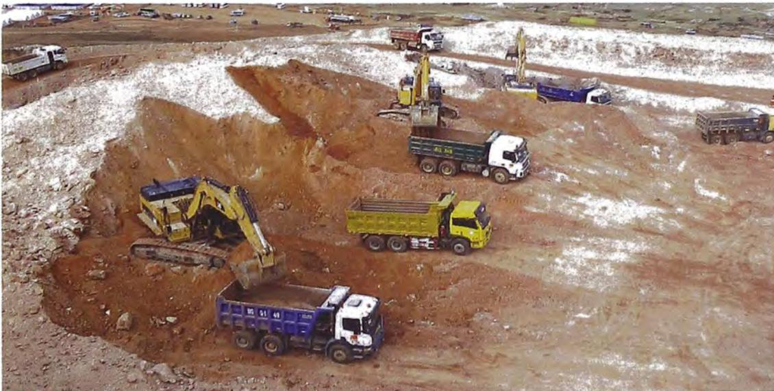
Figura 3.22. Carguío y transporte de roca suelta.
