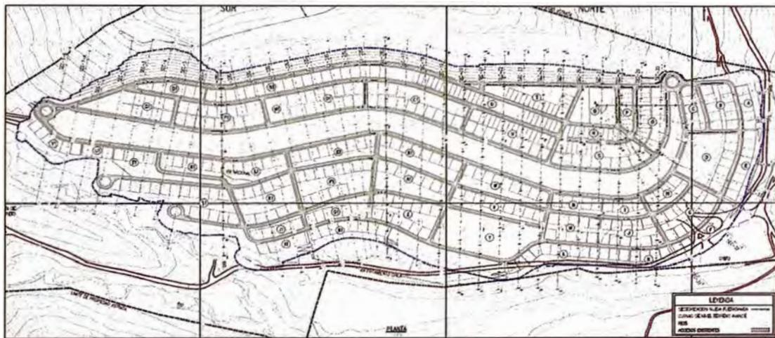
Figura 3.13. Plano de planta de Plataformado de la Ciudad con los ejes para perfiles cada 40m.
