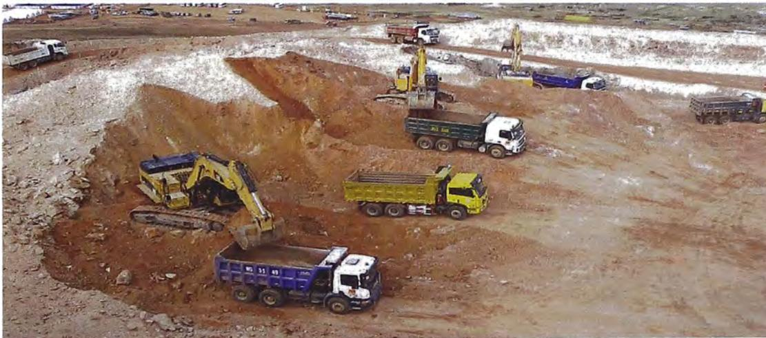
Figura 4.5. Acoplamiento de volquetes en puntos de carguío, ruta y puntos de descarga.
