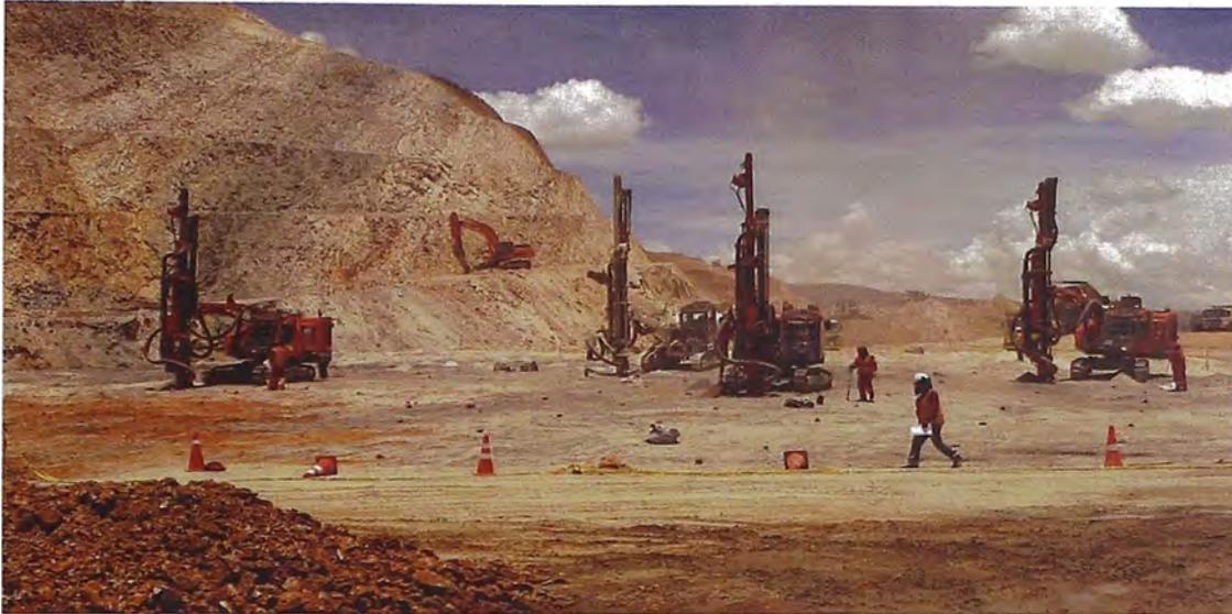
Figura 3.28. Equipos de perforación para voladura habilitando área para carga con explosivos.
