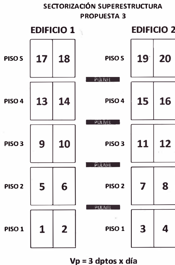
Figura 3.21: Sectorización de Superestructura Propuesta 3
