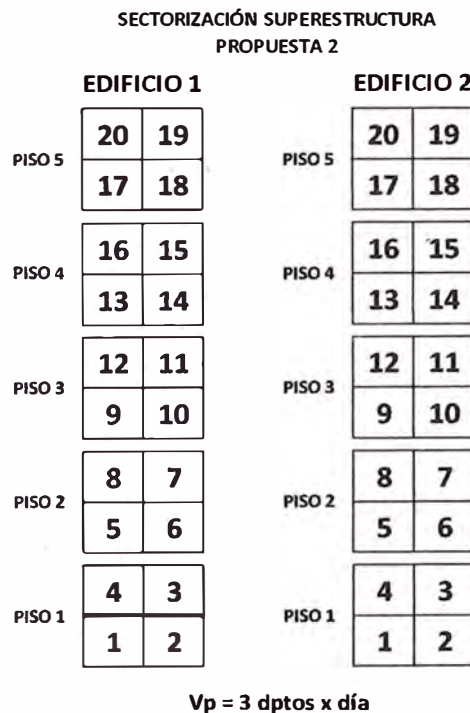
Figura 3.20: Sectorización de Superestructura Propuesta 2
