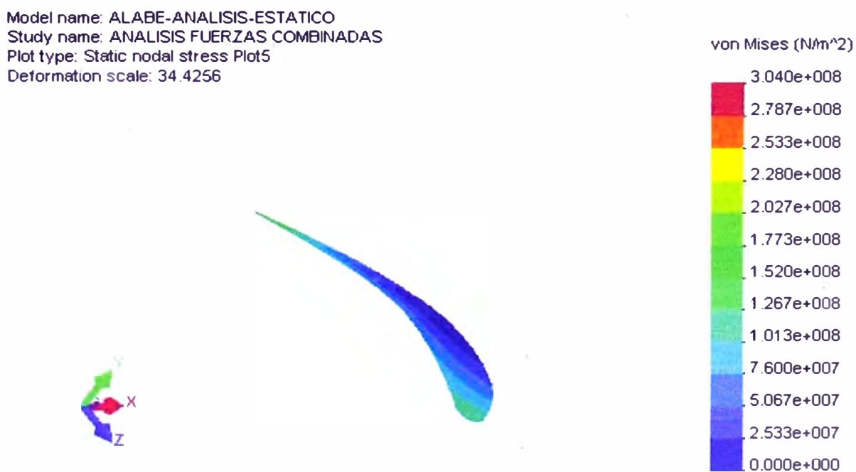
Fig. 4.16 Resultados del análisis estático en el álabo, por acción de fuerzas combinadas, en la sección de la raíz, esfuerzo de von Mises. Se puede observar que el esfuerzo máximo se encuentra en la parte posterior de la raíz del álabo y es de la magnitud de 3.040 \text{ e}+08 \text{ Pa}
