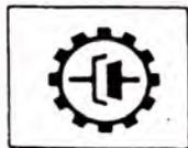
Esta lámpara se enciende cuando interruptor de selector de cierre de transmisión se gira a ENCENDIDO. Si la lámpara monitora está en ENCENDIDO y el pedal del freno izquierdo se presiona, la transmisión regresa a neutral.
