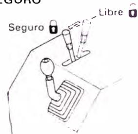
Esta usa para fijar las palancas de control de la aplanadora.
