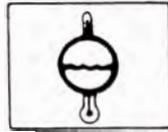
Este monitor indica una elevación en la temperatura del agua de enfriamiento.
