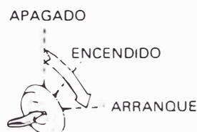
3. Cuando el motor haya arrancado, libere la llave del interruptor de arranque (2) y la llave regresará automáticamente a ENCENDIDO.
