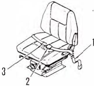
**⚠ Antes de ajustarse la correa de seguridad, inspeccione los soportes y la correa en cuanto a condición.**
