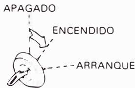
2. El precalentamiento comenzará automáticamente y la lámpara piloto de precalentamiento se encenderá.
