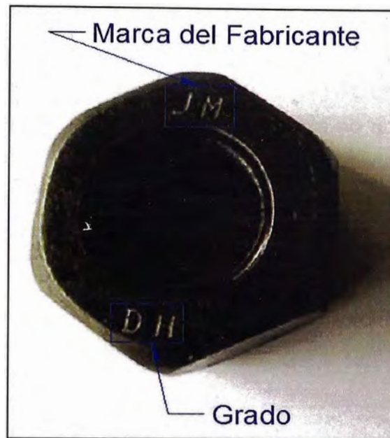
Figura N°1.10.- Ejemplo-Simbología de una tuerca de calidad ASTM A563, Grado DH
