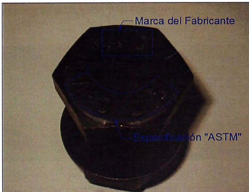
Figura N°1.6.- Ejemplo-Simbología de un perno de calidad ASTM-A325, Tipo 1
