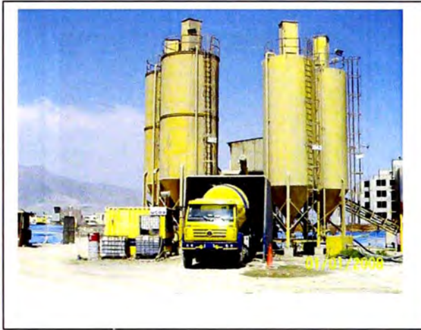
Planta Trujillo, camión mezclador Bajo planta en plena carga de los Materiales.
