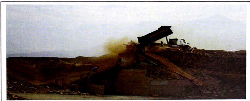
Cantera El Milagro: Camión descargando el hormigón en la zaranda artesanal para su selección en arena y piedra
