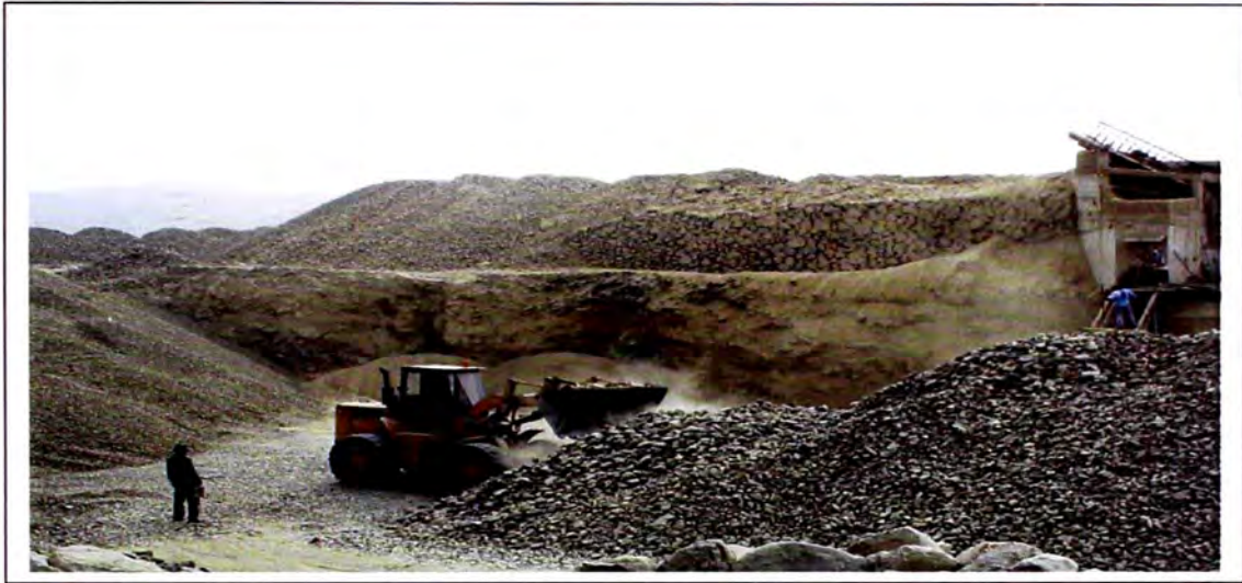
Cantera El Milagro: Separación del material en los puntos de acopio, arena vista izquierda y piedra vista derecha
