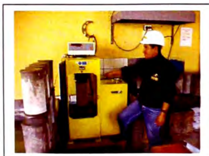
Rotura de las probetas
