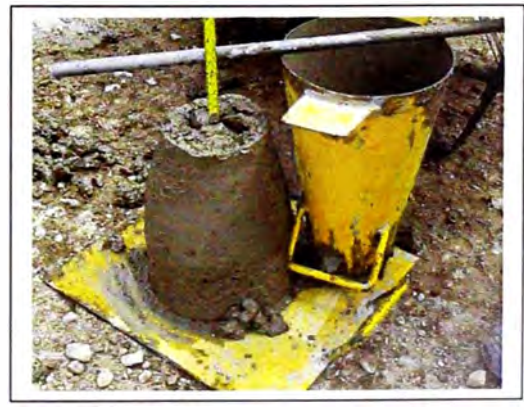
Prueba de Slump del concreto Fresco
