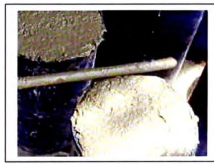
Enrasado final de las Probetas
