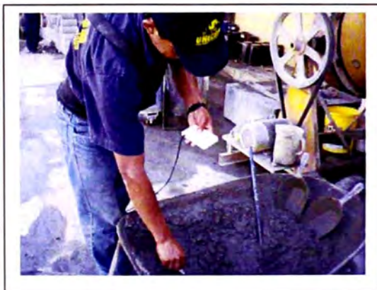
Prueba de temperatura de la concreto Fresco.
