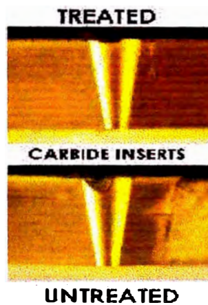
Figura 6.20 – Insertos de carburos antes y después del tratamiento criogénico
