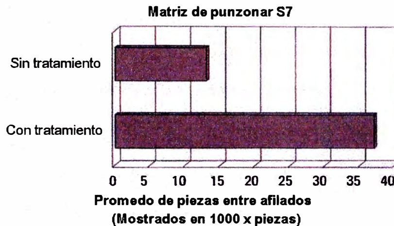
Figura 6.23 – Resultado del tratamiento criogénico en matrices de punzonar
