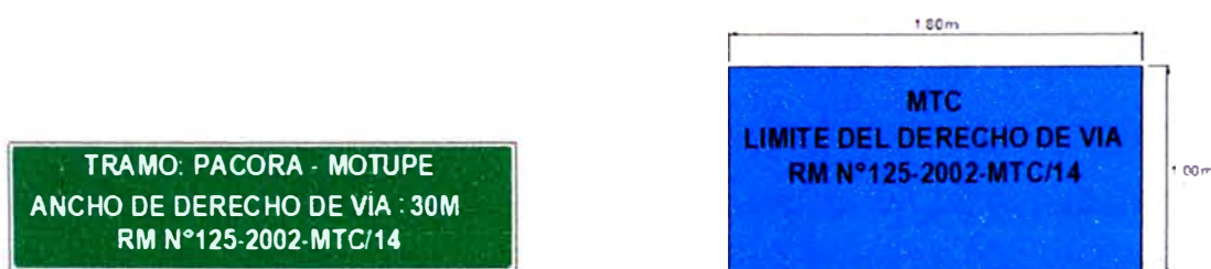
Figura N°1.1.- Modelo de Señal informativa y Murete
