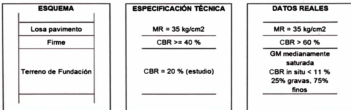
Figura 2.3 - Esquema de la estructura del pavimento
