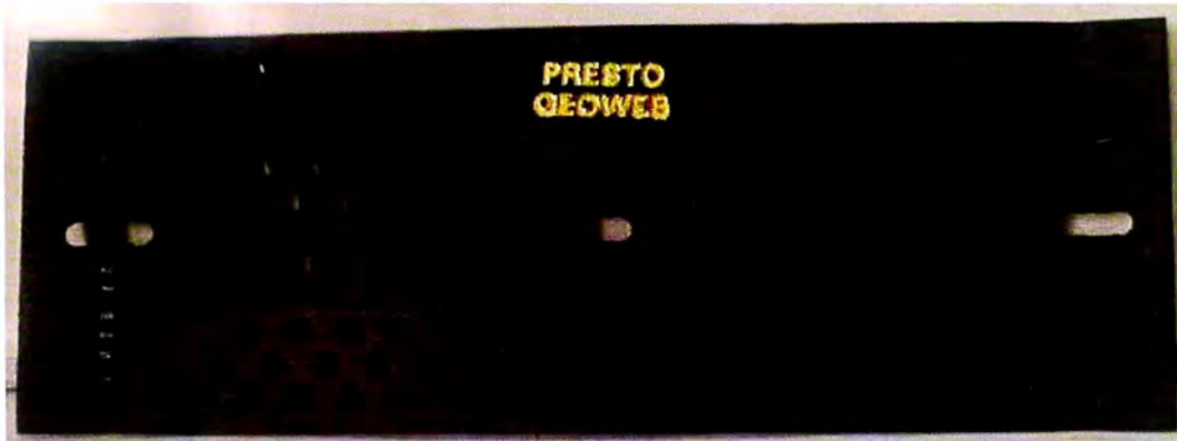
Figura 1.8 - Texturado y perforaciones en Geoweb GKL 12758-1
