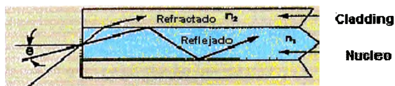
Figura 1: Principio de reflexión interna
