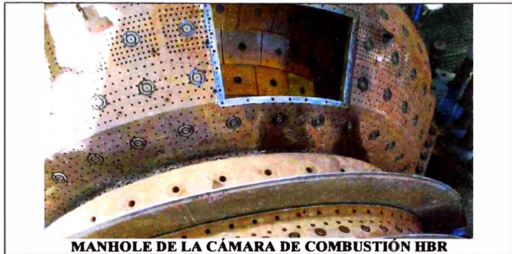
MANHOLE DE LA CÁMARA DE COMBUSTIÓN HBR Figura 32: Cámara de Combustión HBR (Hybrid Burner Ring)
