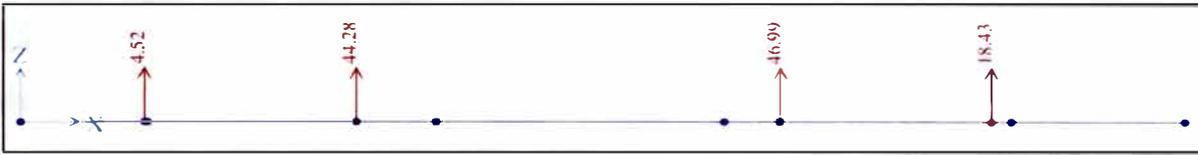
Figura N°3.22.- Reacciones sobre riostra MK (kN).
