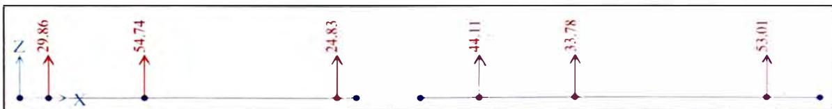
Figura N°3.35.- Reacciones sobre riostra MK (kN).
