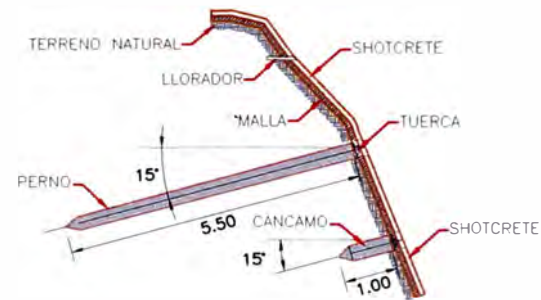
SECCION TIPICA TALUD REFORZADO
