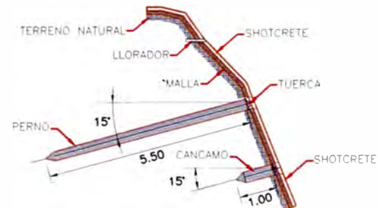
SECCION TIPICA TALUD REFORZADO
