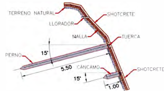
SECCION TIPICA TALUD REFORZADO
