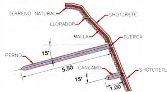
SECCION TIPICA TALUD REFORZADO
