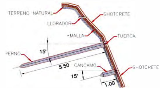
SECCION TIPICA TALUD REFORZADO
