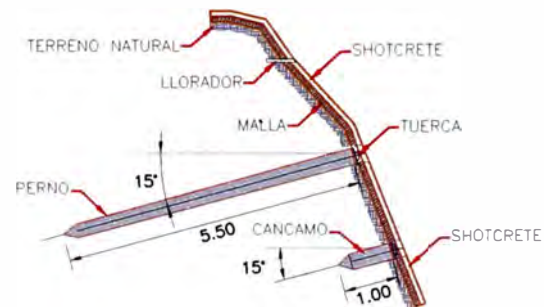
SECCION TIPICA TALUD REFORZADO
