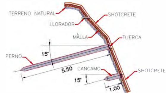
SECCION TIPICA TALUD REFORZADO
