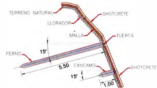
SECCION TIPICA TALUD REFORZADO
