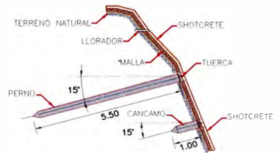
SECCION TIPICA TALUD REFORZADO
