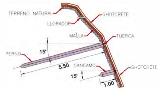
SECCION TIPICA TALUD REFORZADO
