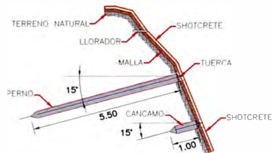
SECCION TIPICA TALUD REFORZADO
