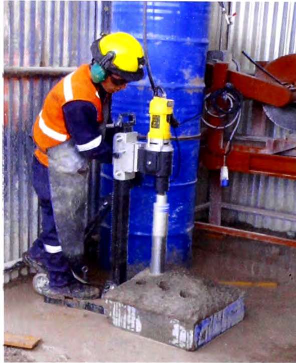
Figura N°4.31.- Extracción de testigo en la muestra de shotcrete (laboratorio insitu).
