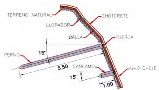
SECCION TIPICA TALUD REFORZADO ESC: 1/100
