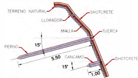
SECCION TIPICA TALUD REFORZADO
