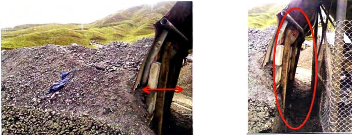
**Figura N° 4.14.- Derecha: Se muestra la separación de la parte frontal desgastada por el peso propio del cargador. Mal diseño de la rampa. Izquierda: Detalle de separación de la rampa. (Fuente: Archivo propio)**
