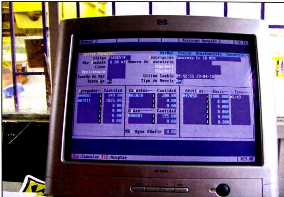
Figura N° 1.4.- Sistema semi computarizado para carguío de concreto (Fuente: Archivo propio).
