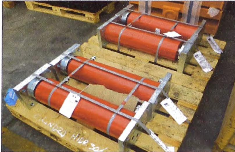
Figura N°2.64: Fotografía Gato de 30T-520C.
