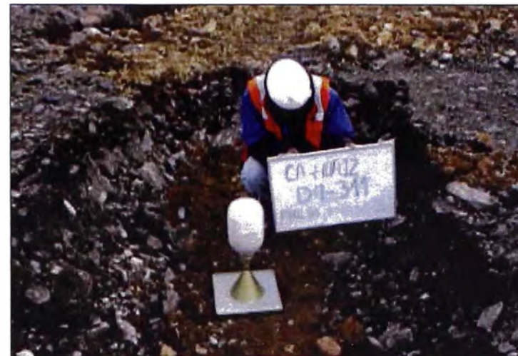
Foto N° 20: Ensayo de densidad de Campo (Método del Cono de Arena) en la Calicata CA-311, dique del depósito de relaves 3.
