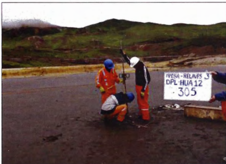
Figura N° 2.4 Vista del ensayo DPL en la relavera
