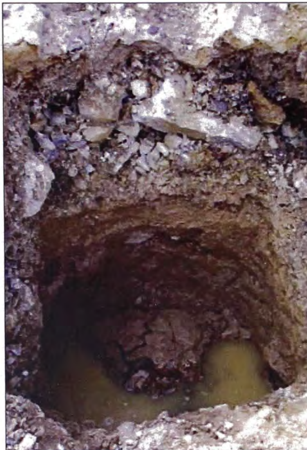
Foto N° 17: Calicata T-01, dique de depósito de relaves 3.
