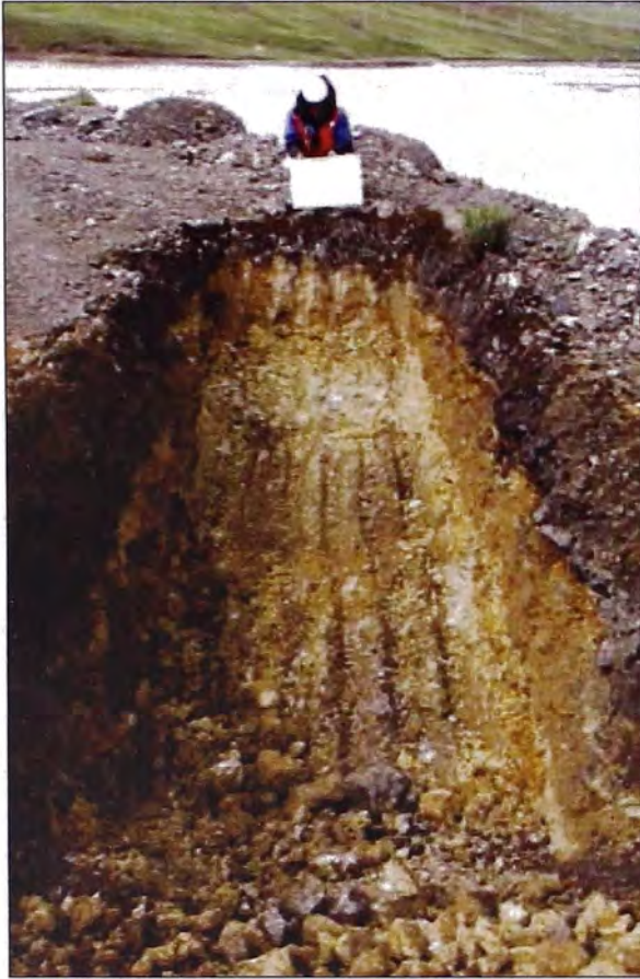
Foto N° 15: Calicata CA-311, dique del depósito de relaves 3.
