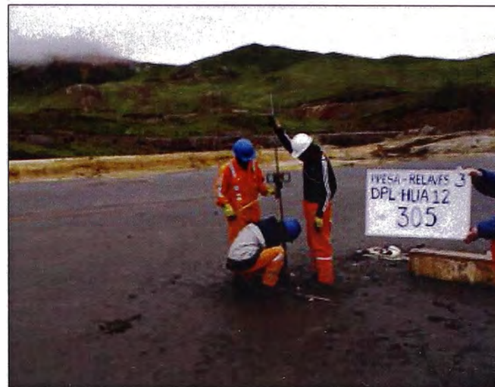
Foto N° 22: Ensayo DPL-305, depósito de relaves 3.
