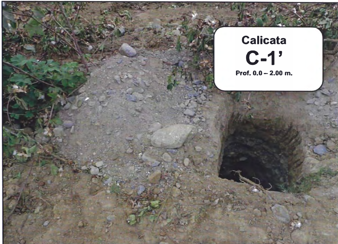
Gráfico N° 2.3 Foto de la Calicata c-1', ubicada en la Zona de la Planta de Tratamiento. Se observa grava con matriz de arena, material de origen aluvial.
