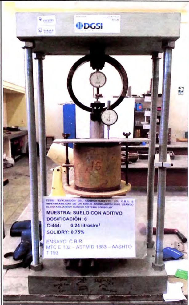
MOLDE EN PRENSA DE C.B.R.
