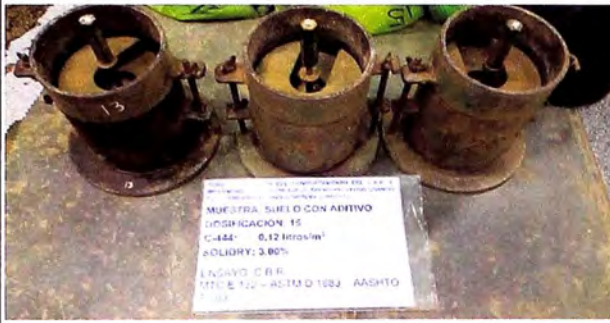
MOLDES DE C.B.R. ANTES DE ENSAYARSE
