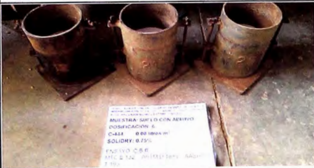
MOLDES DE C.B.R. ANTES DE ENSAYARSE
