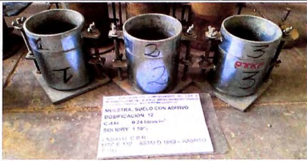
MOLDES DE C.B.R. ANTES DE ENSAYARSE
