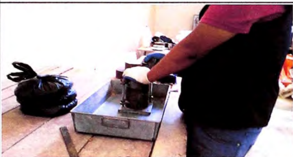
PROCESO DE COMPACTACIÓN DEL ENSAYO DE PROCTOR MODIFICADO
