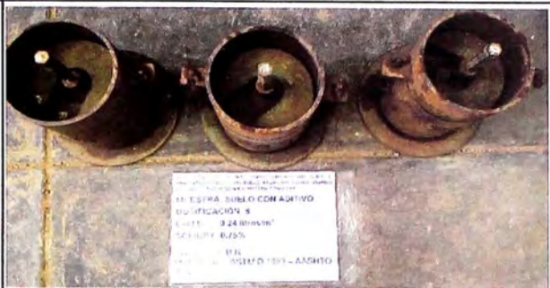
MOLDES DE C.B.R. DESPUÉS DE SATURARSE
