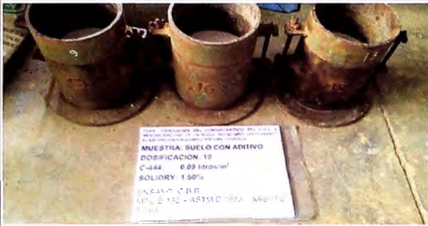
MOLDES DE C.B.R. ANTES DE ENSAYARSE
