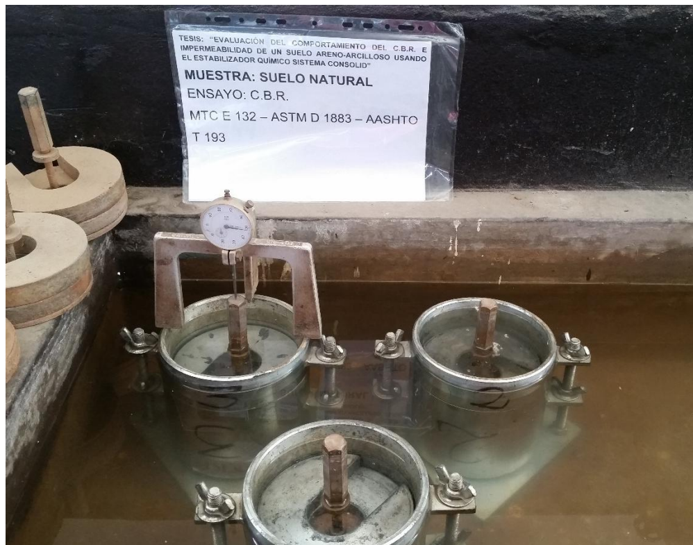
Figura N°3.18 Especímenes de C.B.R. colocados en la poza de saturación.
