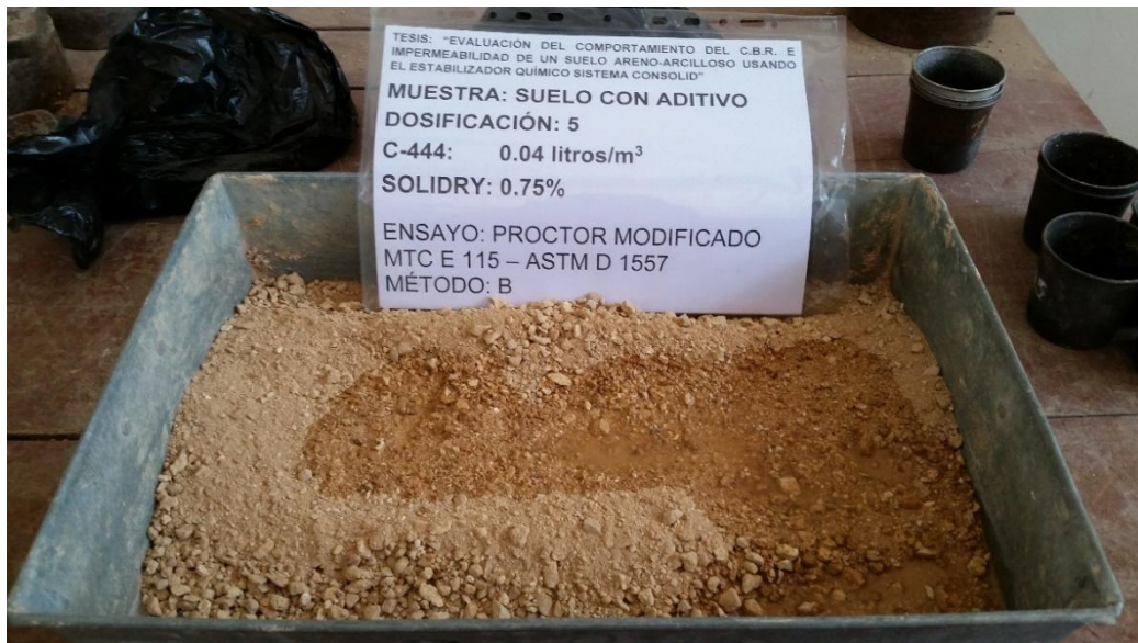
Figura N°3.25 Adición del aditivo Consolid 444 a la muestra de suelo. Fuente: Elaboración Propia.
