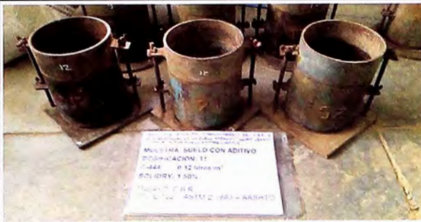
MOLDES DE C.B.R. ANTES DE ENSAYARSE
