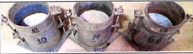
MOLDES DE C.B.R. ANTES DE ENSAYARSE
