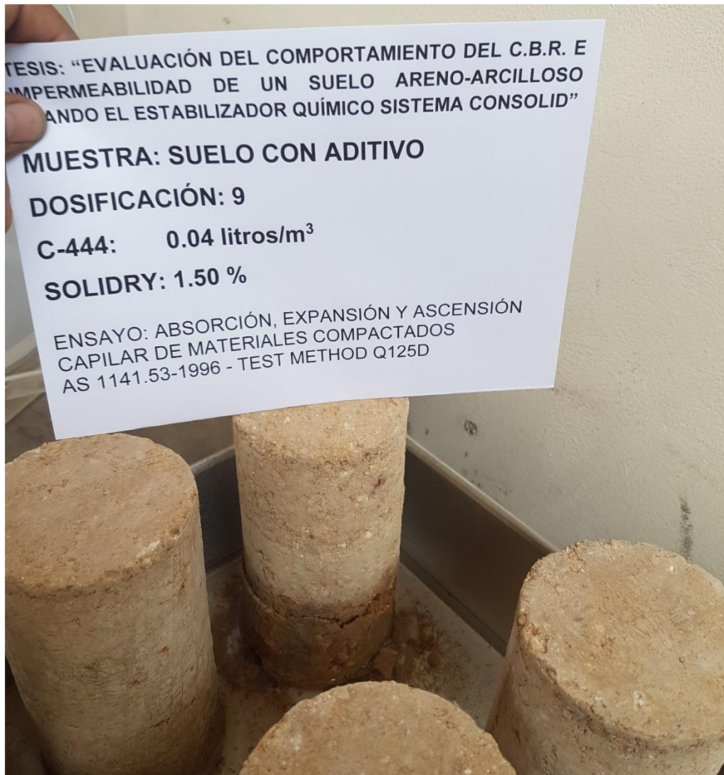
Figura N°4.10 Espécimen 1 de la dosificación 9 que presenta desmoronamiento. Fuente: Elaboración Propia.
