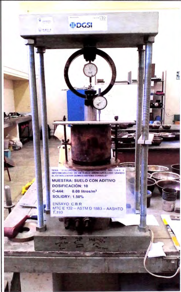
MOLDE EN PRENSA DE C.B.R.
