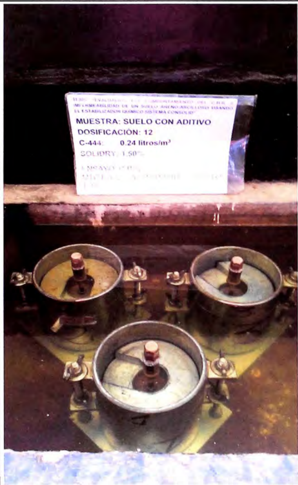
MOLDES DE C.B.R. EN SATURACIÓN
