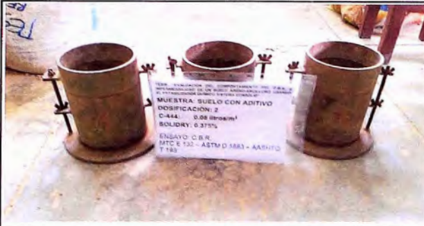
MOLDES DE C.B.R. ANTES DE ENSAYARSE
