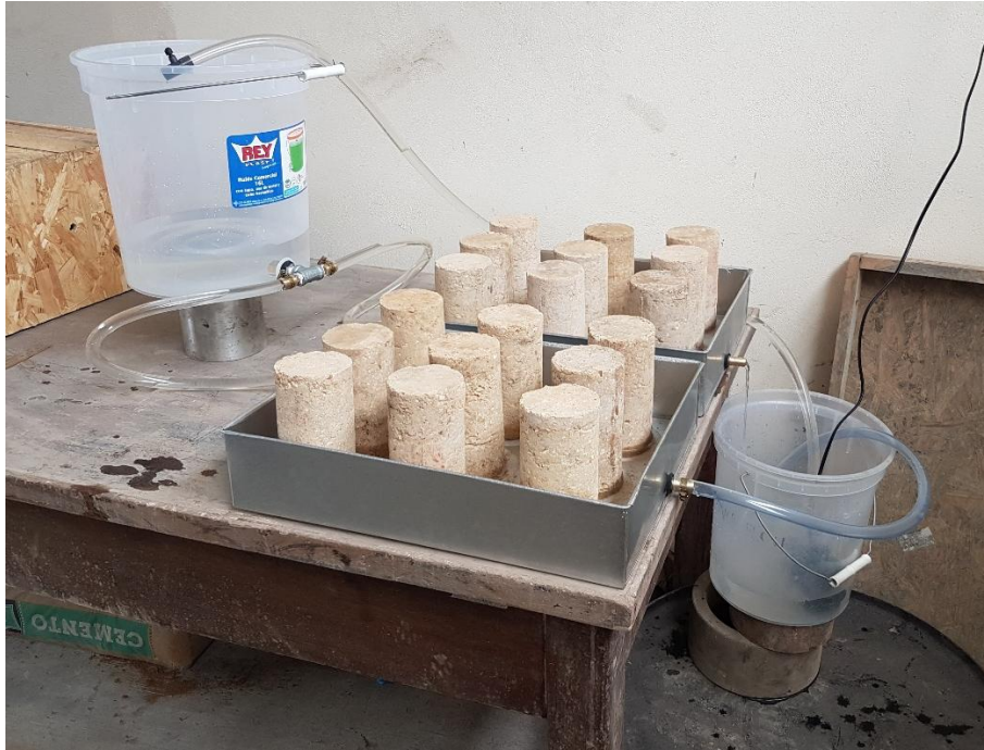
Figura N°3.23 Equipo para Ensayo de Ascensión Capilar. Fuente: Elaboración Propia.
