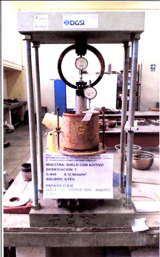
MOLDE EN PRENSA DE C.B.R.
