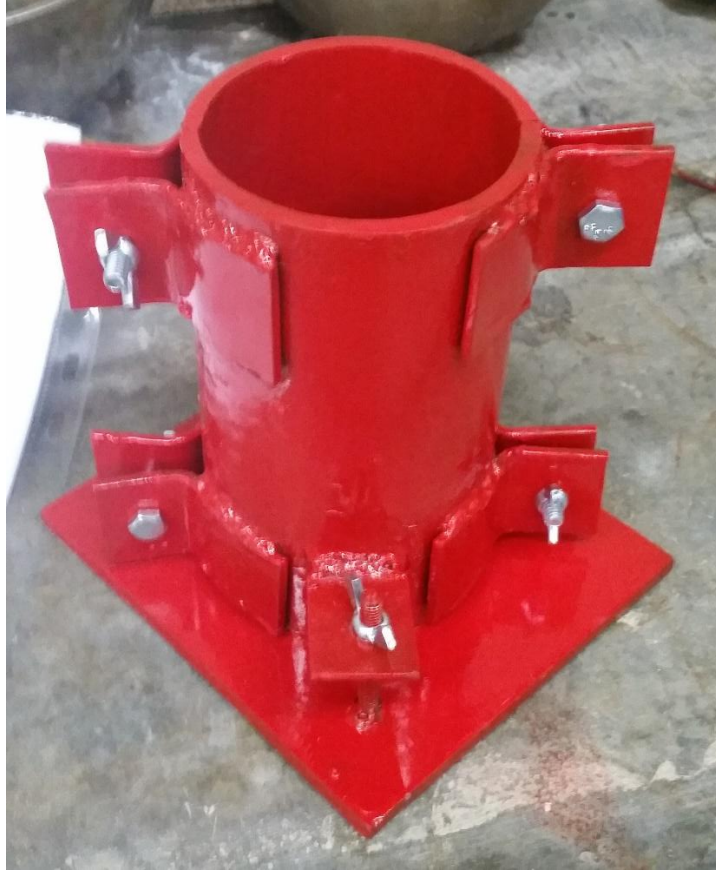
Figura N°3.19 Molde de diámetro 7.95 cm y altura de 15.9 cm. Fuente: Elaboración Propia.
