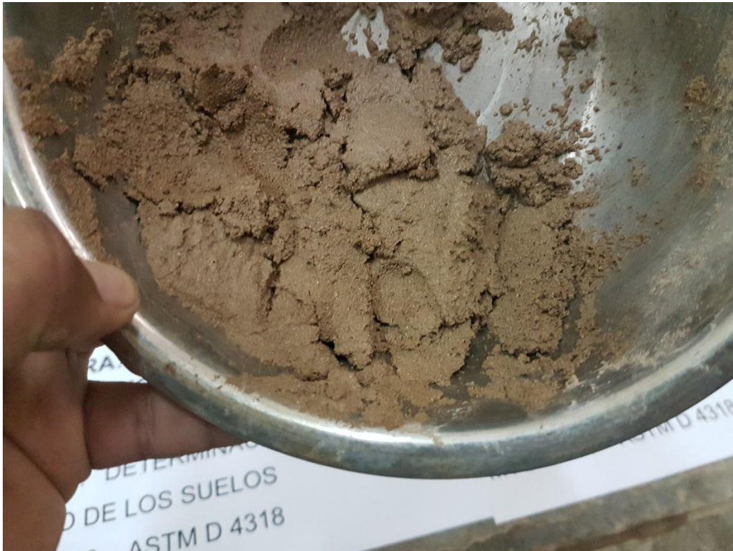
Figura N°4.20 Muestra de Suelo-Cemento que no presenta plasticidad. Fuente: Elaboración Propia.
