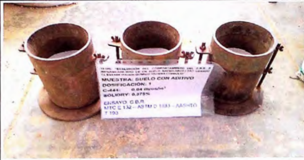
MOLDES DE C.B.R. ANTES DE ENSAYARSE
