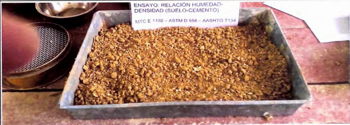
MEZCLA DE SUELO CON CEMENTO
