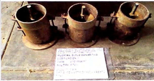
MOLDES DE C.B.R. ANTES DE ENSAYARSE
