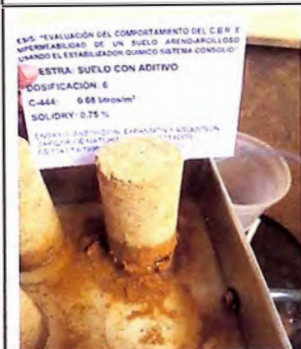
DOSIFICACIÓN 6 - FALLA A 24 HORAS
