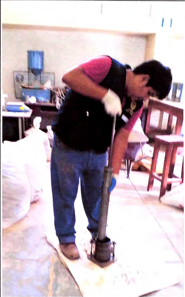
PROCESO DE COMPACTACIÓN DEL ENSAYO DE PROCTOR MODIFICADO
