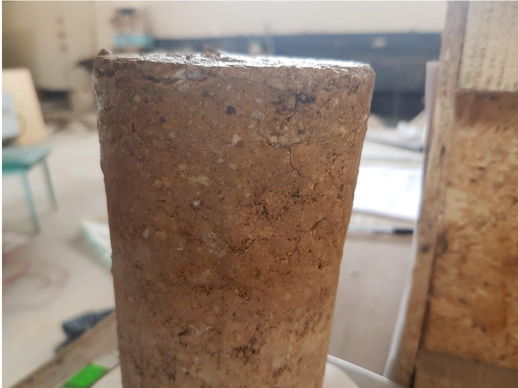
Figura N°4.16 Espécimen con presencia de fisuras debido a la expansión diametral. Fuente: Elaboración Propia.
