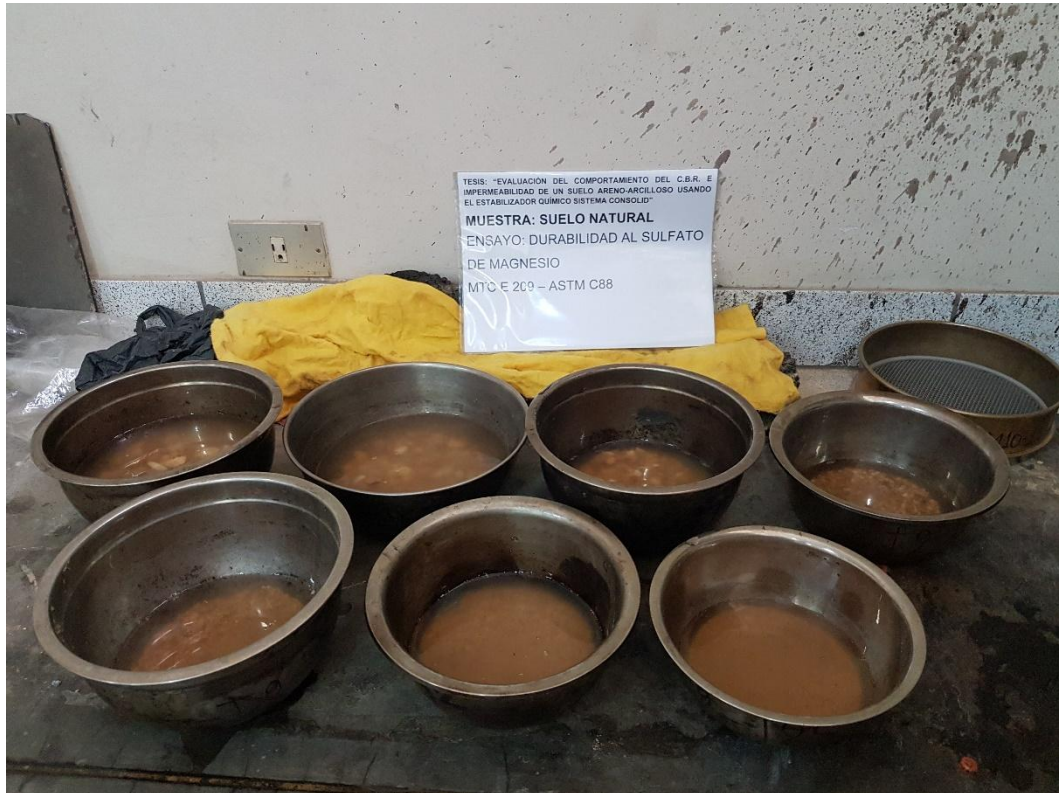
Figura N°3.15 Muestras de Agregado Grueso y Fino saturadas en Sulfato de Magnesio. Fuente: Elaboración Propia.
