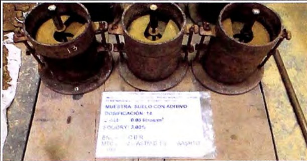
MOLDES DE C.B.R. ANTES DE ENSAYARSE
