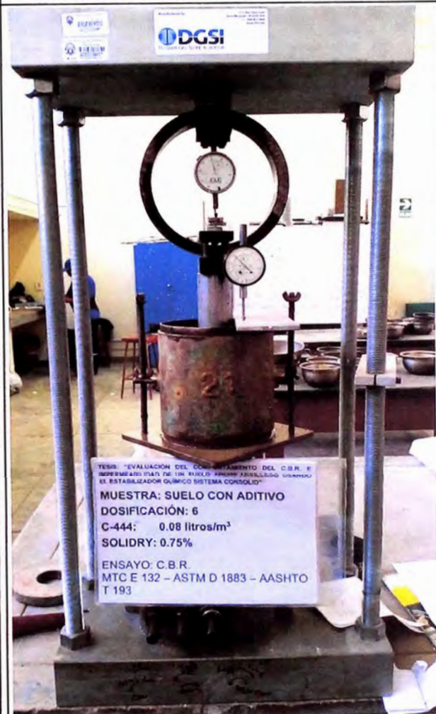
MOLDE EN PRENSA DE C.B.R.
