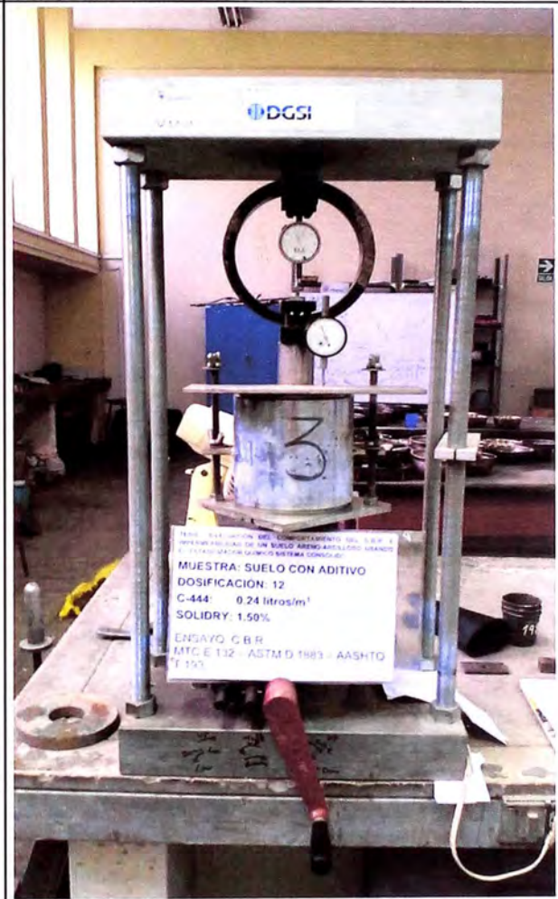
MOLDE EN PRENSA DE C.B.R.
