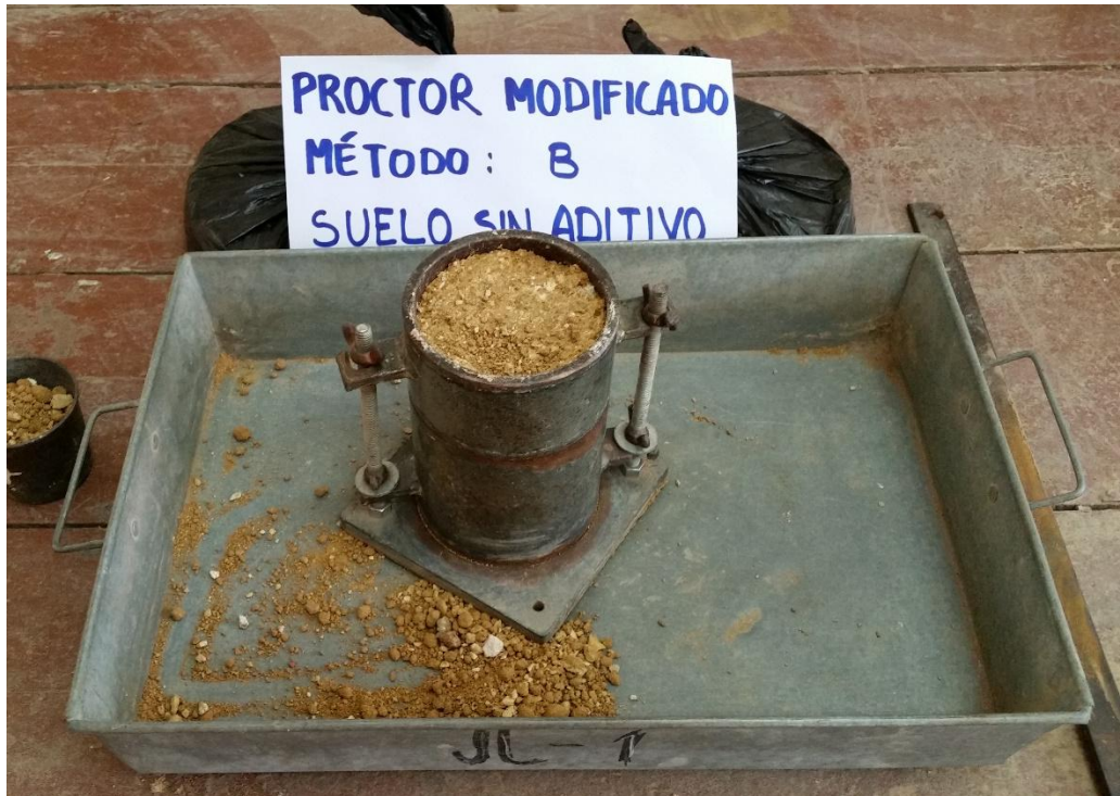
Figura N°3.16 Molde de 4" con suelo compactado por el método de Proctor Modificado.
