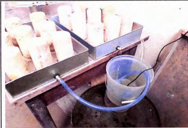
SALIDA DE AGUA DE REBOSE
