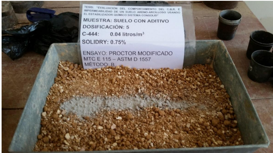
Figura N°3.26 Adición del aditivo Solidry a la muestra de suelo. Fuente: Elaboración Propia.
