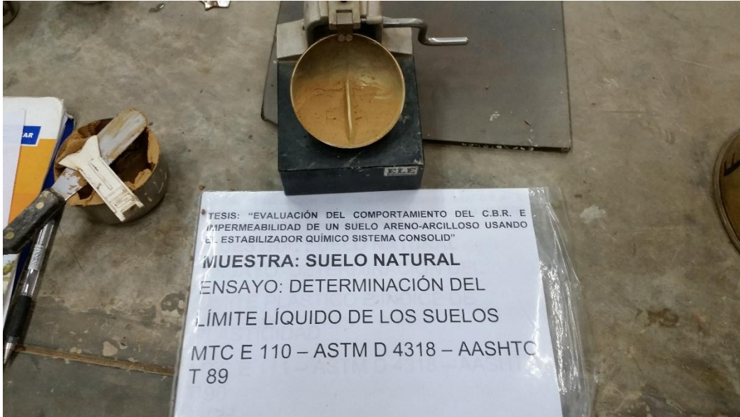
Figura N°3.4 Copa de Casagrande para Ensayo de Límite Líquido. Fuente: Elaboración propia.
