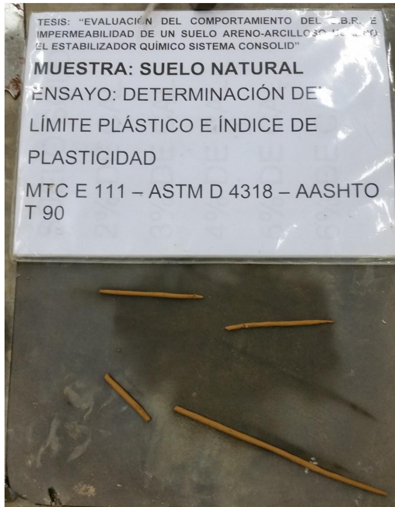
Figura N°3.6 Ensayo para determinar el Límite Plástico del suelo. Fuente: Elaboración propia.
