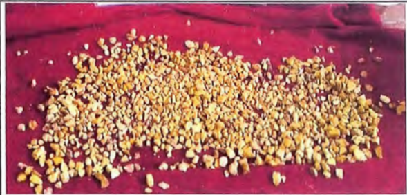
MATERIAL RETENIDO EN EL TAMIZ N° 4 SATURADO SUPERFICIALMENTE SECO
