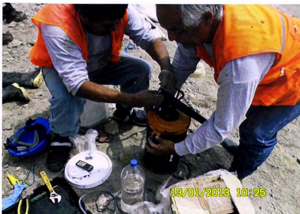
Fotografía N° 26 Ajustes previos de la bomba de inyección.
