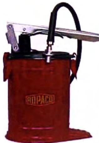
**Fotografía N° 1.- Bomba manual, manguera flexible y boquilla de engrase**
