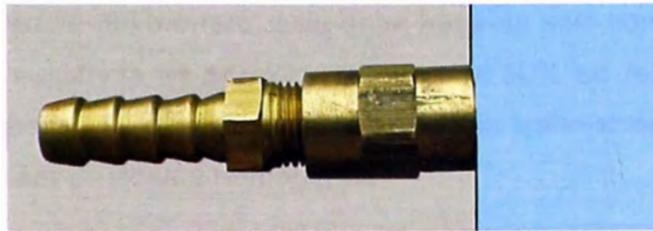
**Figura N° 7.- Espiga y unión al ras del concreto existente**
