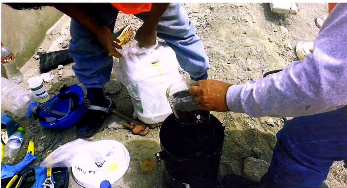
Fotografía N° 25 Colocación del recipiente dentro del contenedor de la bomba manual.
