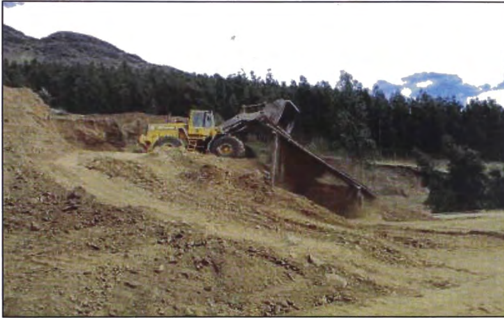
Figura N°5.18.- Zarandeo del material
