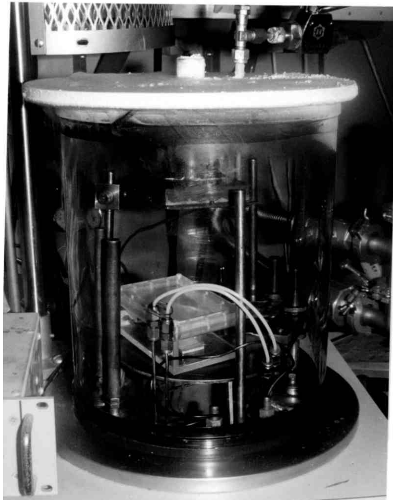
fig. 3.60 a) Esquema de la cámara de vacío simulando condiciones climáticas especiales, con la finalidad de evaluar el rendimiento radiativo de las películas de depositadas sobre Al. b) Fotografía del dispositivo enfriador donde se aprecia el plato frío CP, la caja de plexiglas Px, la muestra S y la cámara de vacío V
