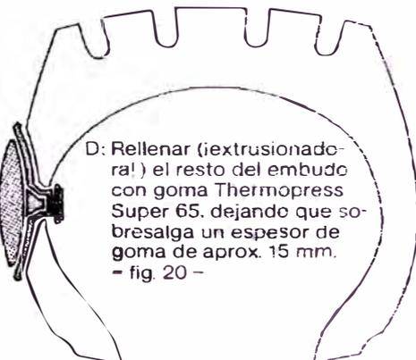
D: Rellenar (extrusidora!) el resto del embudo con goma Thermopress Super 65, dejando que sobresalga un espesor de goma de aprox. 15 mm.
