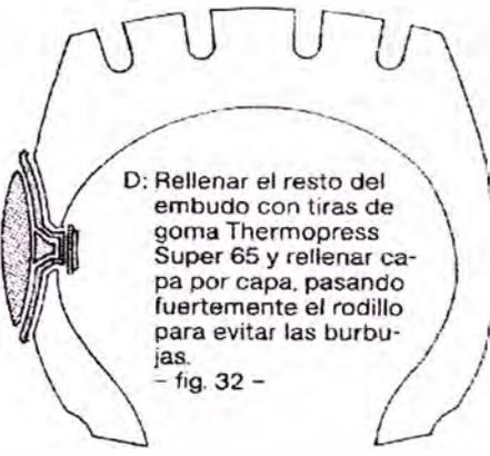
D: Rellenar el resto del embudo con tiras de goma Thermopress Super 65 y rellenar capa por capa, pasando fuertemente el rodillo para evitar las burbujas.
