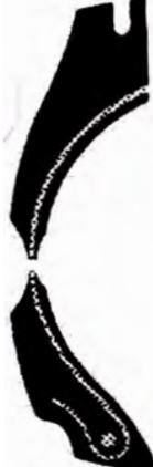
La preparación del embudo está terminada una vez que los extremos de los cables de acero hayan sido pulidos y no sean perceptibles y que los extremos de la rotura queden limitados interior y exteriormente.
